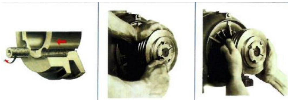
Figura 2.34 Revisión de casquillos y poleas
