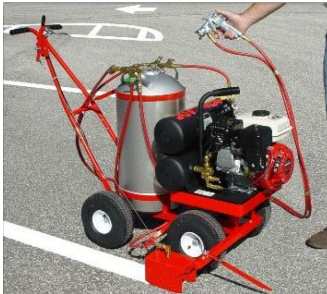
Figura 3.6 Sistema de rociado con aire.
