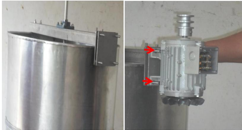
**Gráfico No. 68:** *Soporte del motor y tensor de bandas*
