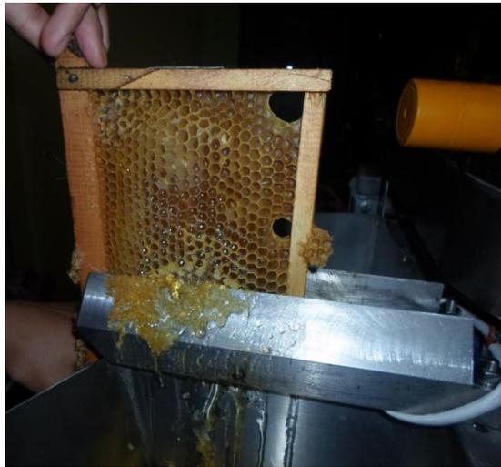
**Gráfico No. 92: Pruebas del sensor capacitivo**
