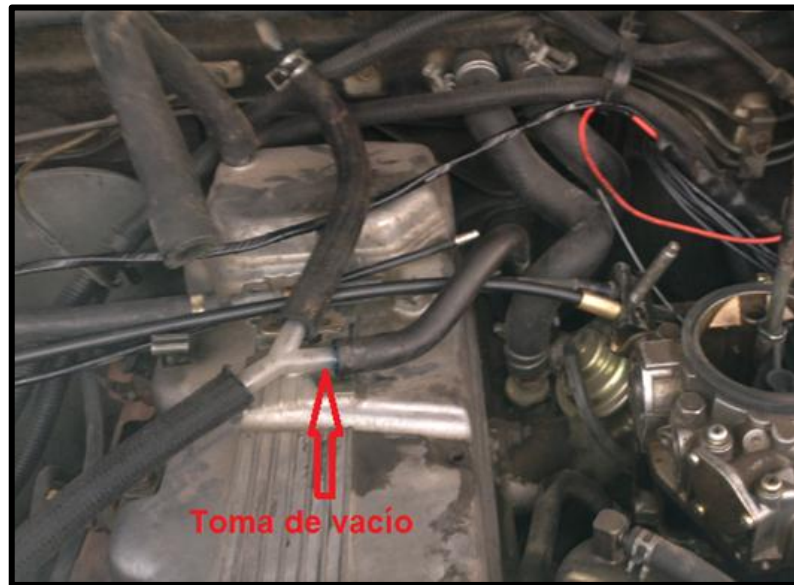
Figura 4.7: Conexión de vacío
