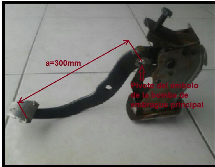
Figura 3.4: Fuerza aplicada en el final del pedal de embrague
