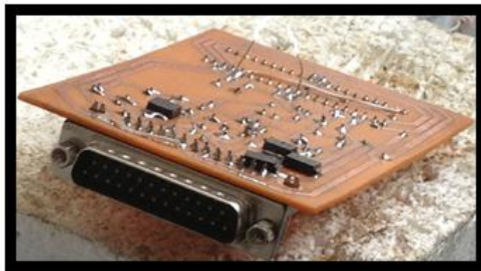
Figura D. 1: Placa del circuito terminada
