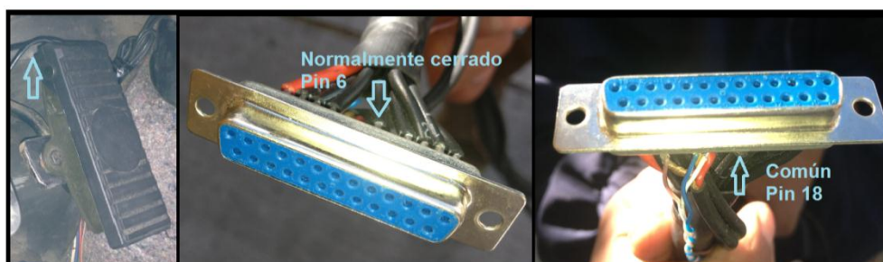
Figura 4.20: Conexión eléctrica del interruptor de aceleración
