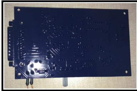
Figura D.2: Placa electrónica protegida contra el óxido
