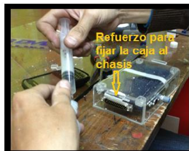
Figura D. 7: Montaje del módulo electrónico dentro del vehículo
