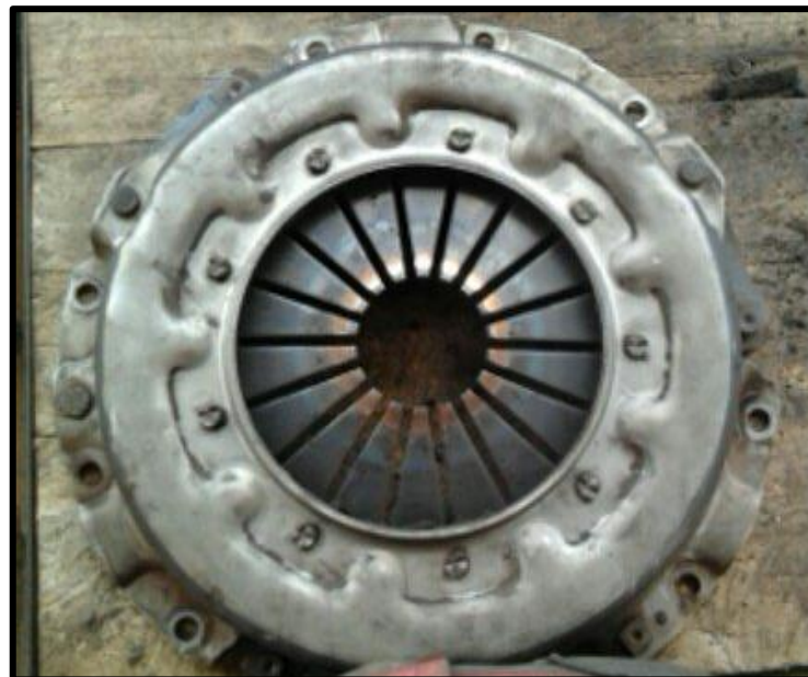
Figura 2.11: Carcasa y Muelle de diafragma visible
