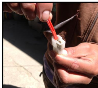
Figura 4.42: Limpieza de sockets del sistema
