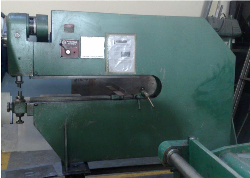
**FIG. 4.27 Máquina Pullmax**
