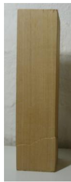
Ilustración 3-3 Probeta ensayada (Compresión paralela)
