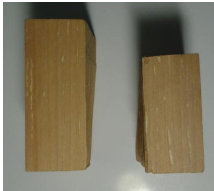
Ilustración 3-24 Probeta ensayada (Corte)
