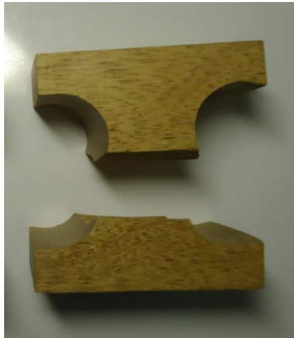
Ilustración 3-20 Probeta ensayada (Tracción perpendicular )
