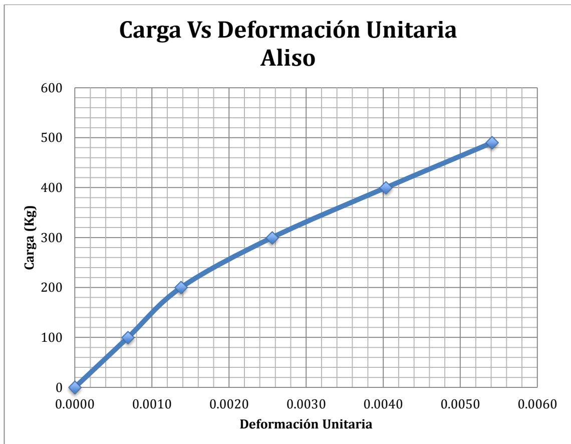
Ilustración 3-15 Grafico carga vs deformación (Aliso)
