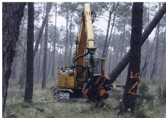
Ilustración 1-28 Apeo y procesado con cosechadora.
