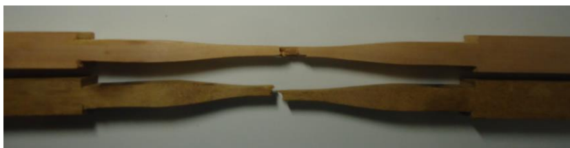
Ilustración 3-13 Probeta ensayada (Tracción paralela )
