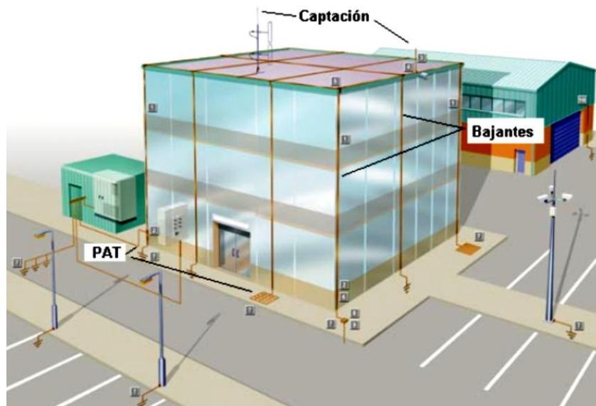
**Figura 11.- Puesta a tierra de protección atmosférica.**
