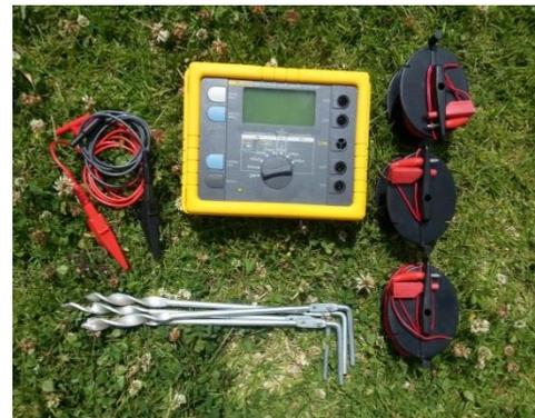
**Figura 27.- Medidor Digital de Resistencia de Puesta a Tierra Fluke 1625**
