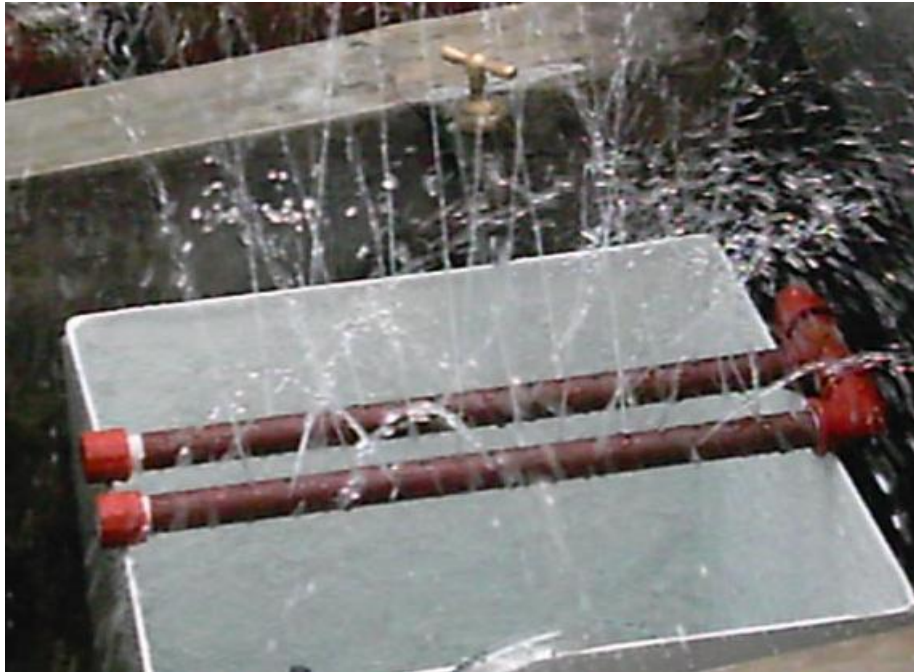
Figura 5.1 Funcionamiento orificios de las flautas.
