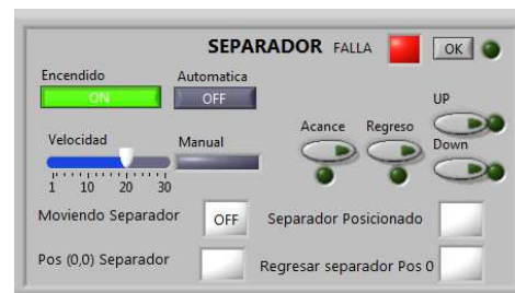
Figura 4.31 Alarma de falla del sistema separador 189
