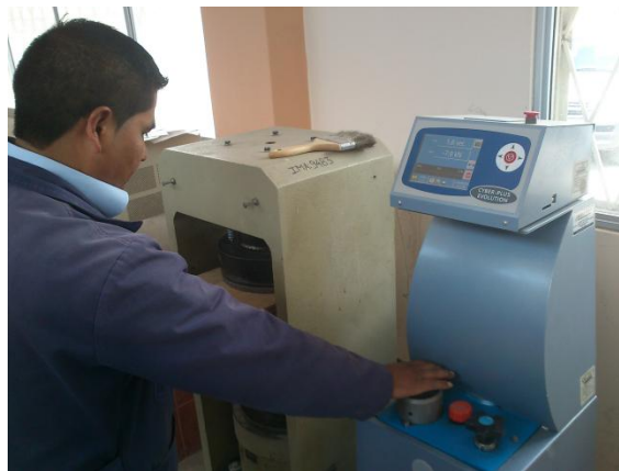
figura 4. Ejecución del ensayo de compresión
