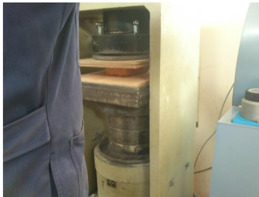
figura 3. Colocación de ladrillo en la máquina de compresión
