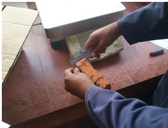
figura 1. Toma de dimensiones de las probetas
