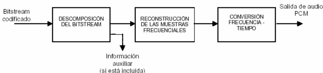
**Figura. 2. 8. Diagrama de bloques de un decodificador MPEG-1.**
