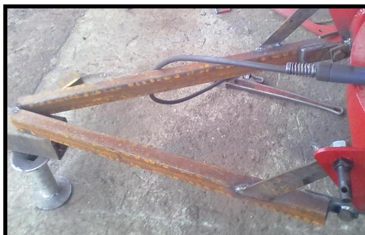
Figura 4. 17. Bases para el soporte de la abonadora
