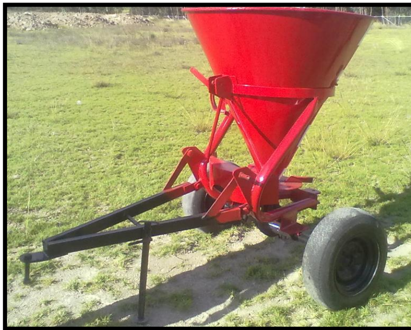
Figura 4. 18. Abonadora lista para realizar sus pruebas de funcionamiento.
