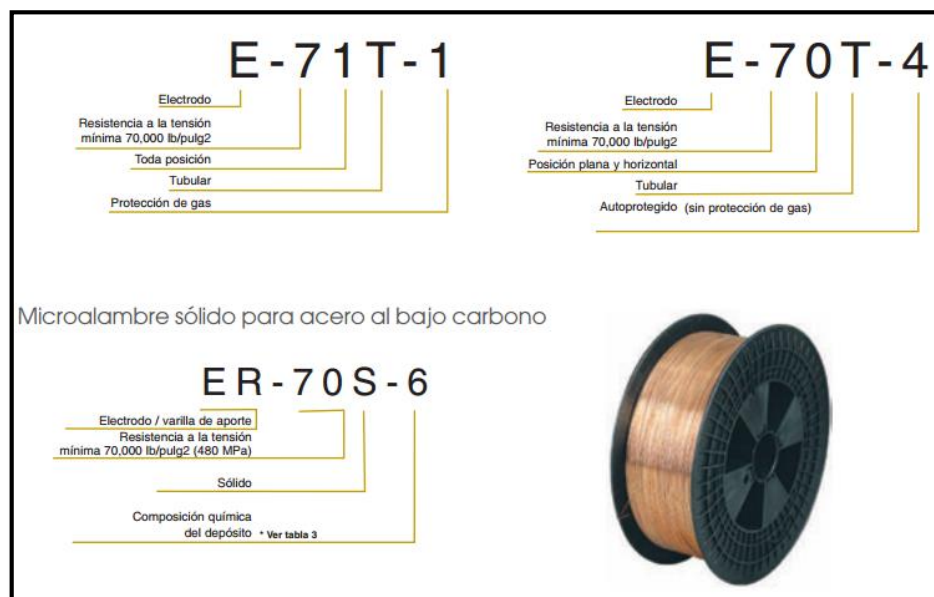
Figura 2. 14. Clasificación de alambre según la AWS para procesos GMAW
