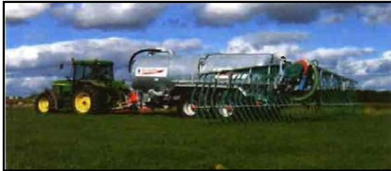
Figura 2. 22. Tanque de purín con sistema de distribución de barra con tubos colgantes.
