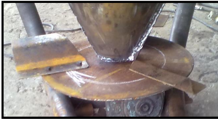
Figura 4. 13. Paletas distribuidoras de abono
