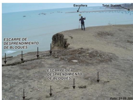
**Figura 5.** Evidencias de escarpes continuos de desprendimiento de bloques.
