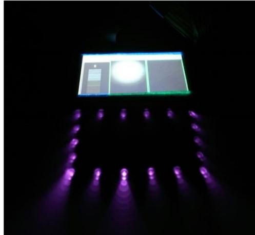
**Figura 4. 27. Funcionamiento luces infrarrojas de la cámara de reconocimiento facial**
