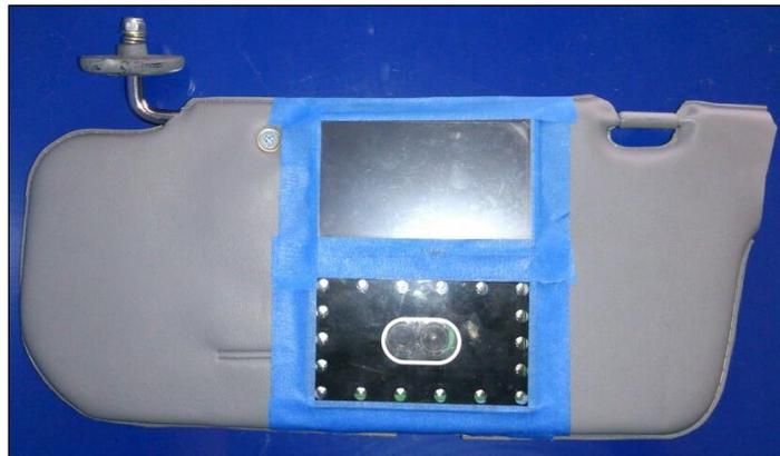
**Figura 4. 17. Instalación de la cámara de reconocimiento facial en la visera del piloto.**
