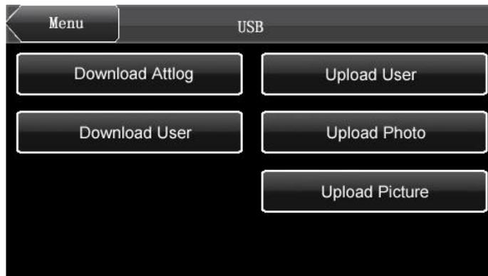
**Download Alllog:** Descarga todos los ingresos al dispositivo a través del USB.
