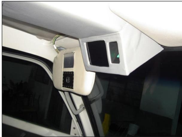
**Figura 4. 26. Instalación del sistema de reconocimiento facial terminada**
