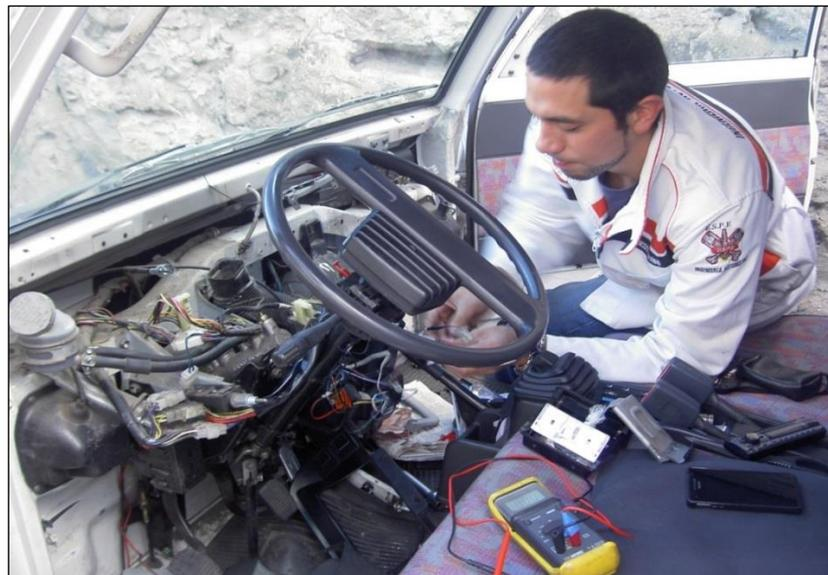
**Figura 4. 20. Tablero del vehículo desarmado para el cableado.**
