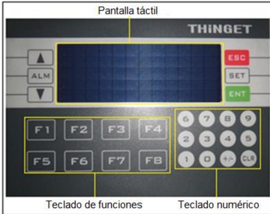
El Controlador Lógico Programable es un dispositivo electrónico de estado sólido que puede controlar un proceso y que tiene la capacidad de ser programado o reprogramado rápidamente según la demanda de la aplicación
