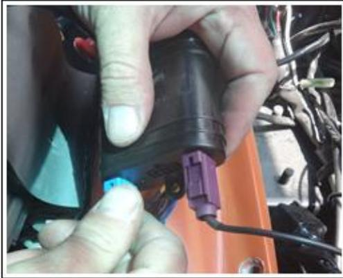
La antena GSM es una antena pasiva y omnidireccional, por lo cual la orientación o posición no es un factor determinante, sin embargo es importante evitar interferencias eléctricas de componentes que inducen campos como la radio, entre otros, es por esta razón que se mantuvo gran distancia con estos elementos.
