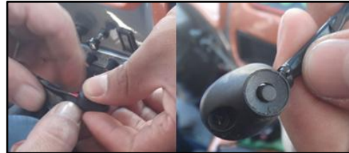
Figura 6. Conexión del botón de pánico
