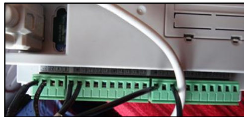
Figura 10. Conexión de entradas y salidas al PLC
