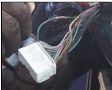
Figura 9. Conexión del cable de freno motor
