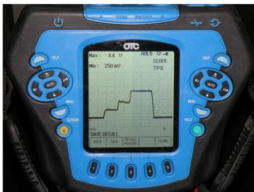
**Figura 4:** Oscilograma sensor TPS
