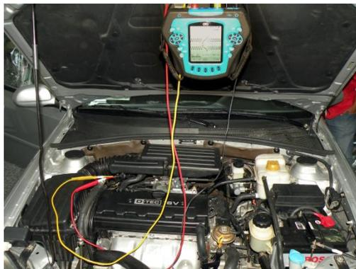
**Figura 3:** Osciloscopio conectado a los inyectores
