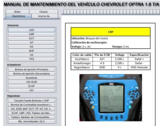
**Figura 8:** Procedimiento electrónico del manual electrónico
