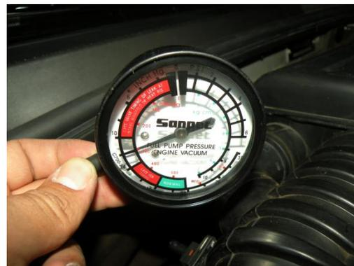
**Figura 5:** Medición de presión de vacío
