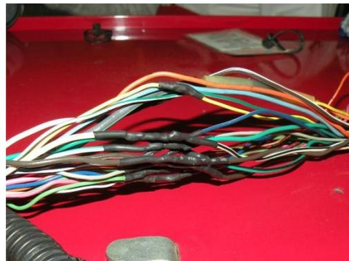
**Figura 2:** cableado reparado
