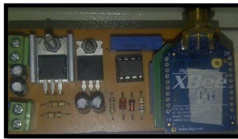
**Figura 2.23:** Placa Estación PH Acoplamiento de Elementos
