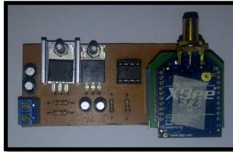
**Figura 2.22:** Placa Repetidores Acoplamiento de Elementos
