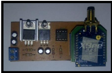
Fig. 20: Acoplamiento de Elementos Placa Estaciones Repetidora
