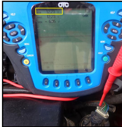
Figura 5. 57: Comprobación del voltaje de alimentación de la válvula EGR lineal.
