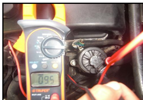
Figura 5. 58: Medición de la resistencia del devanado de la válvula EGR lineal.
