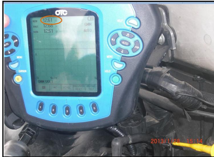
Figura 5. 19: Toma de medición y valor de voltaje en KOEO del primer terminal del solenoide EVR.
