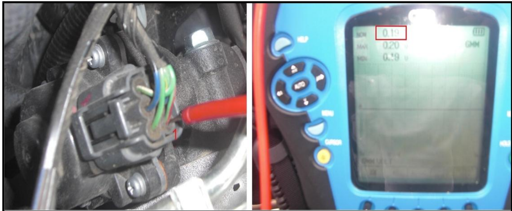
Figura 5. 26: Toma de medición y valor de voltaje en KOEO del primer terminal de la válvula EGR de motor paso a paso.
