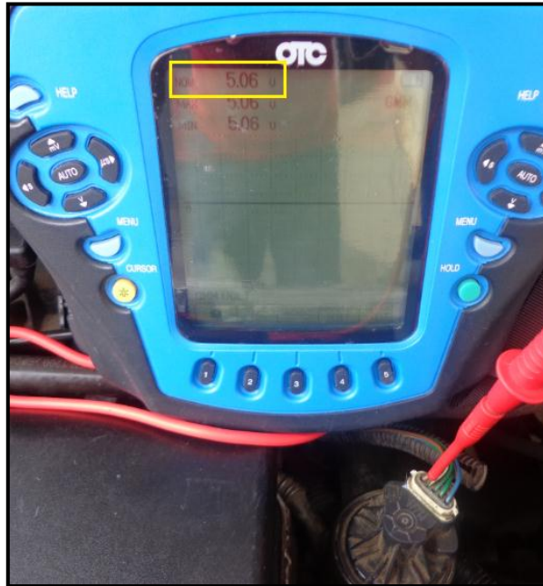
Figura 5. 37: Toma de medición y valor de voltaje en KOEO del cuarto terminal de la válvula EGR lineal.
