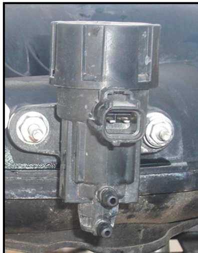
Figura 2. 21: Forma física real del solenoide EVR.
