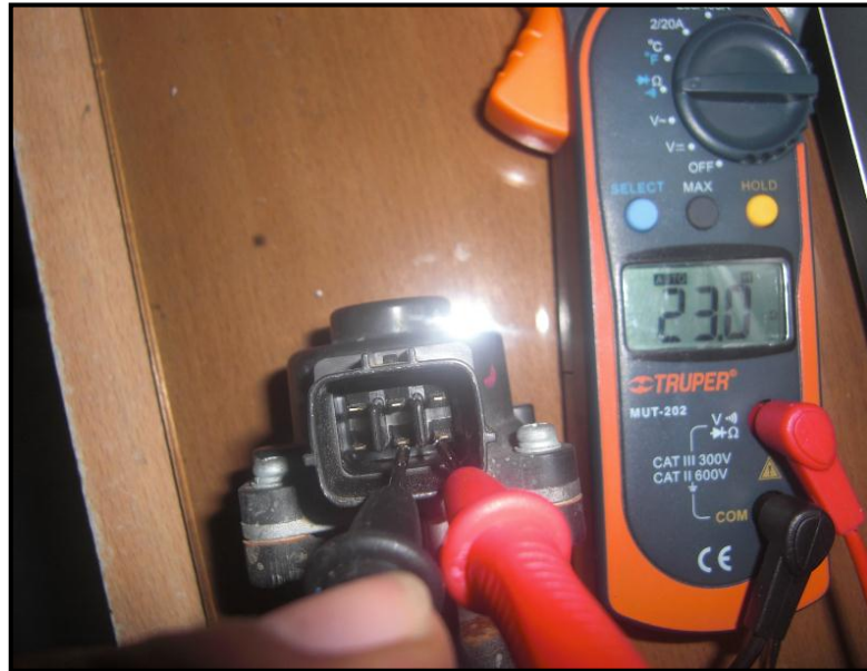
Figura 5. 55: Medición de la resistencia de la bobina E-D de la válvula EGR de motor paso a paso.
