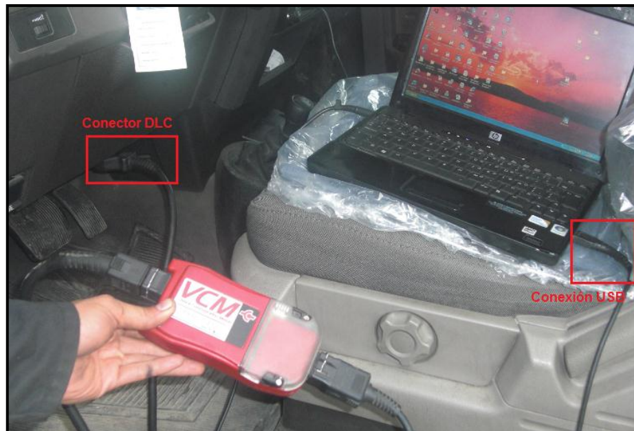
Figura 5. 75: Conexión del VCM al DLC y Laptop.
