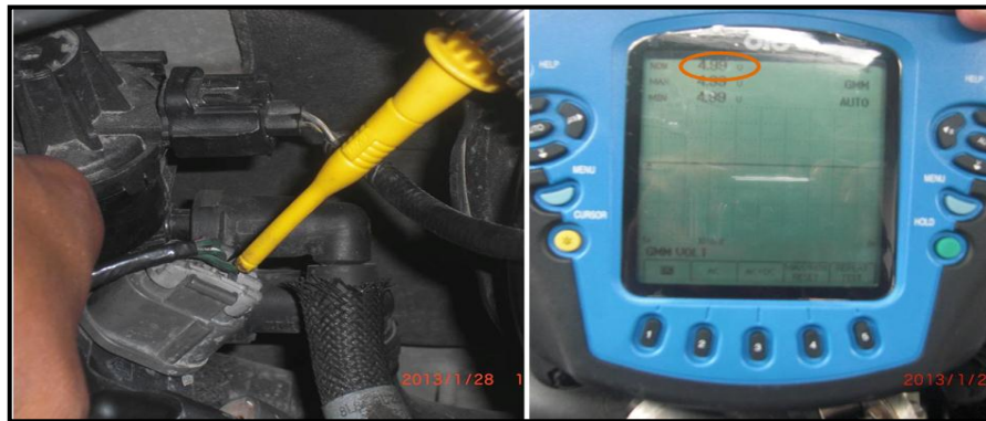
Figura 5. 21: Toma de medición y valor de voltaje en KOEO del primer terminal del sensor DPFE.
