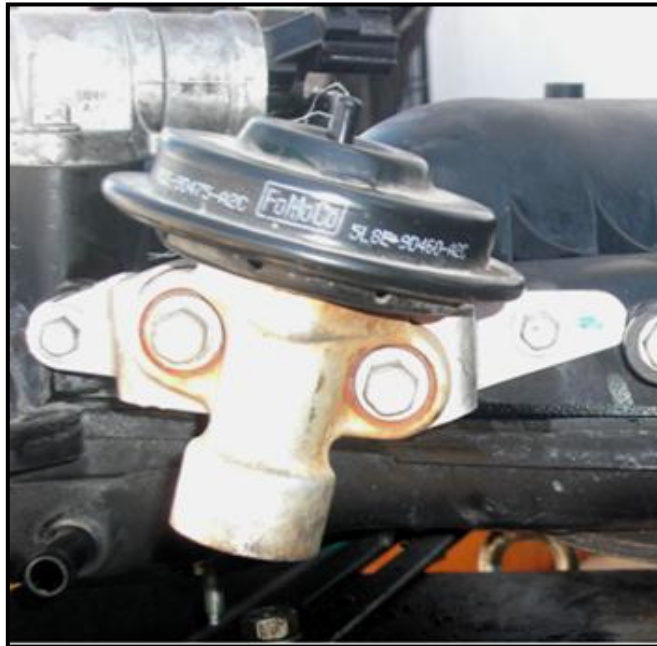
Figura 2. 18: Construcción física real de una válvula EGR neumática.
