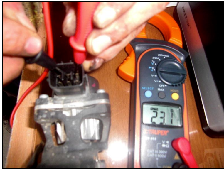
Figura 5. 53: Medición de la resistencia de la bobina B-A de la válvula EGR de motor paso a paso.
