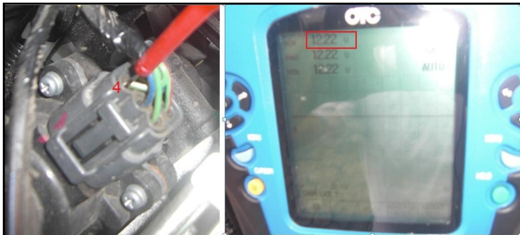
Figura 5. 29: Toma de medición y valor de voltaje en KOEO del cuarto terminal de la válvula EGR de motor paso a paso.
