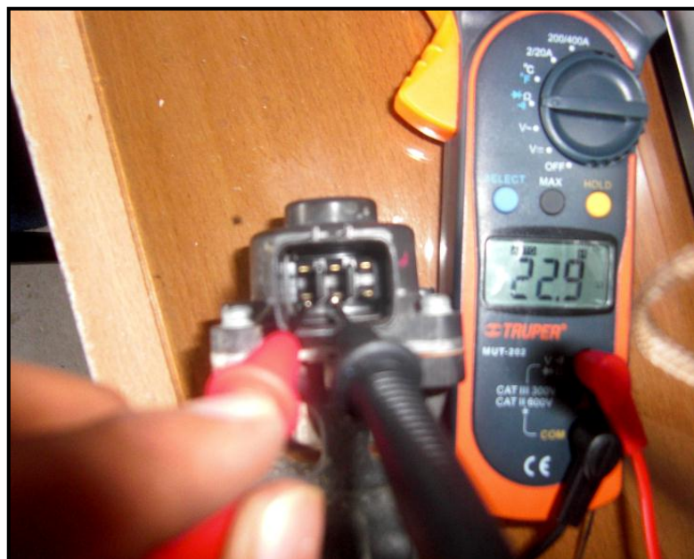
Figura 5. 56: Medición de la resistencia de la bobina E-F de la válvula EGR de motor paso a paso.
