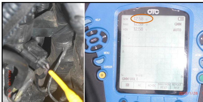
Figura 5. 20: Toma de medición y valor de voltaje en KOEO del segundo terminal del solenoide EVR.
