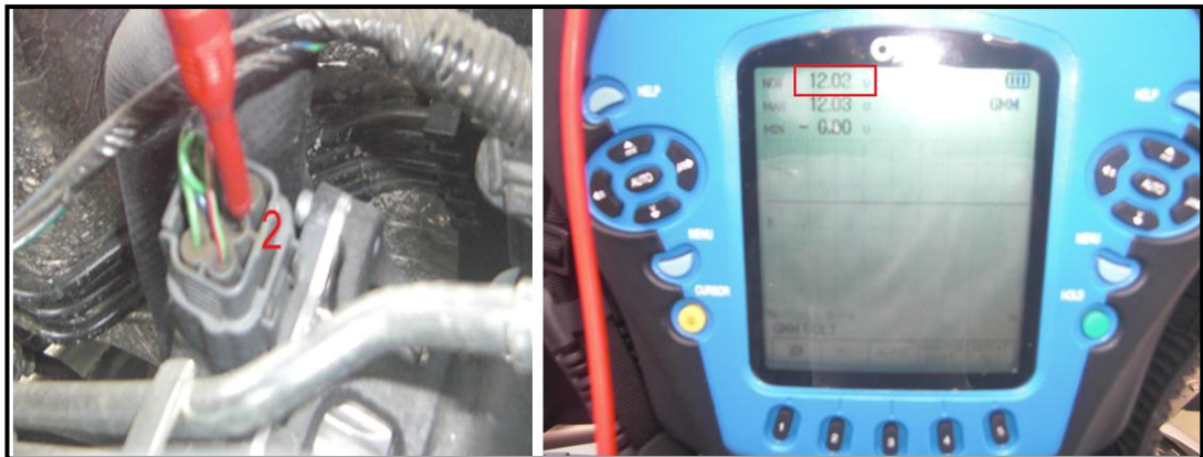
Figura 5. 51: Comprobación del voltaje de alimentación de la válvula EGR de motor paso a paso.
