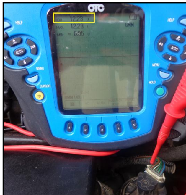
Figura 5. 38: Toma de medición y valor de voltaje en KOEO del quinto terminal de la válvula EGR lineal.
