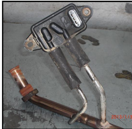
Figura 2. 25: Construcción física real del sensor DPFE.
