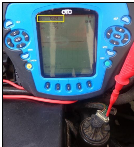
Figura 5. 34: Toma de medición y valor de voltaje en KOEO del primer terminal de la válvula EGR lineal.
