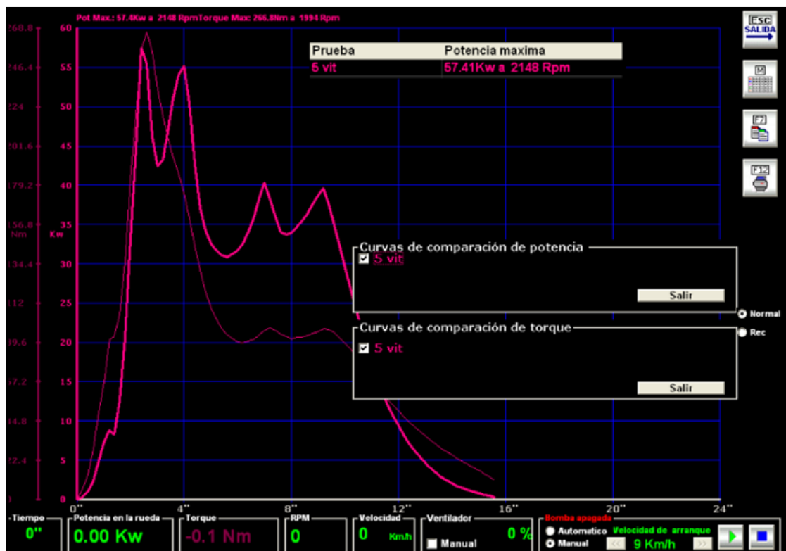
Figura 5. 69: Prueba 2 en el dinamómetro sin EGR.
