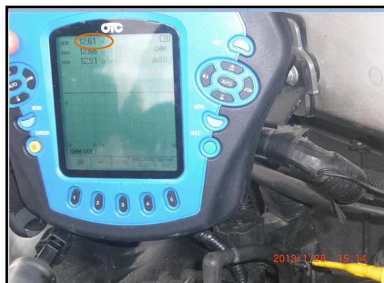
Figura 5. 49: Comprobación del voltaje de alimentación del solenoide EVR.
