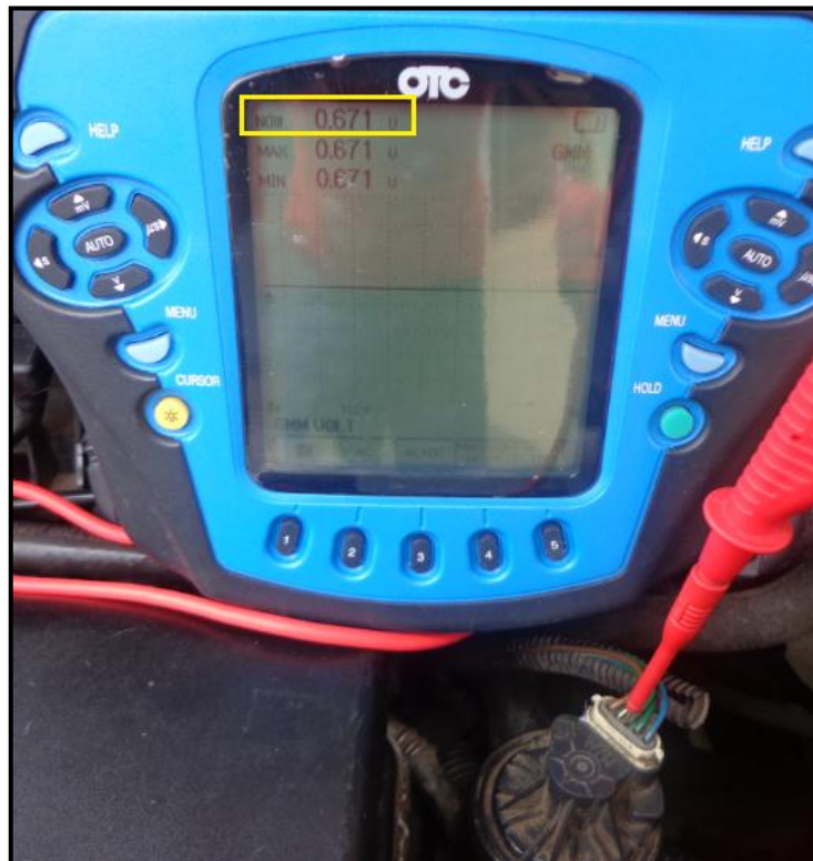
Figura 5. 36: Toma de medición y valor de voltaje en KOEO del tercer terminal de la válvula EGR lineal.
