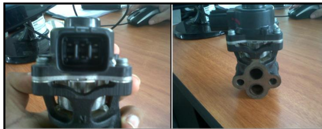
Figura 2. 33: Construcción física real de una válvula EGR de motor paso a paso.
