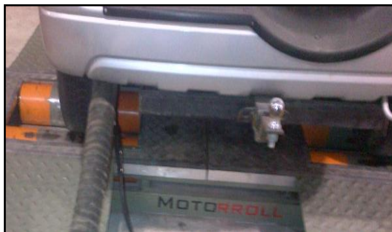
Figura 5. 65: Conexión de la sonda flexible y la manguera.
