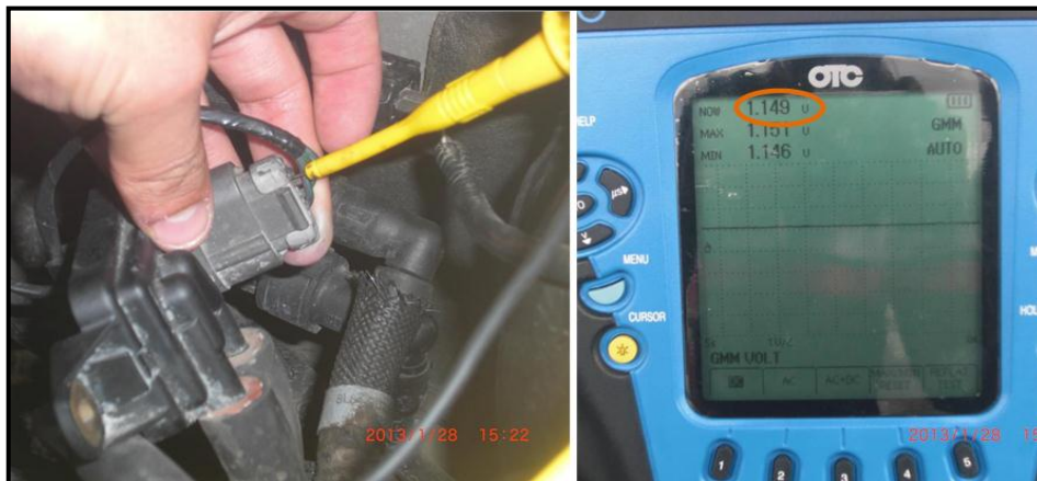
Figura 5. 23: Toma de medición y valor de voltaje en KOEO del tercer terminal del sensor DPFE.
