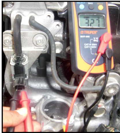
Figura 5. 60: Medición de la resistencia de la válvula de purga del Cánister
