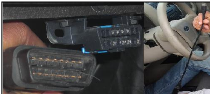
Figura 5. 71: Conectores de 16 pines OBDII y adaptador USB.
