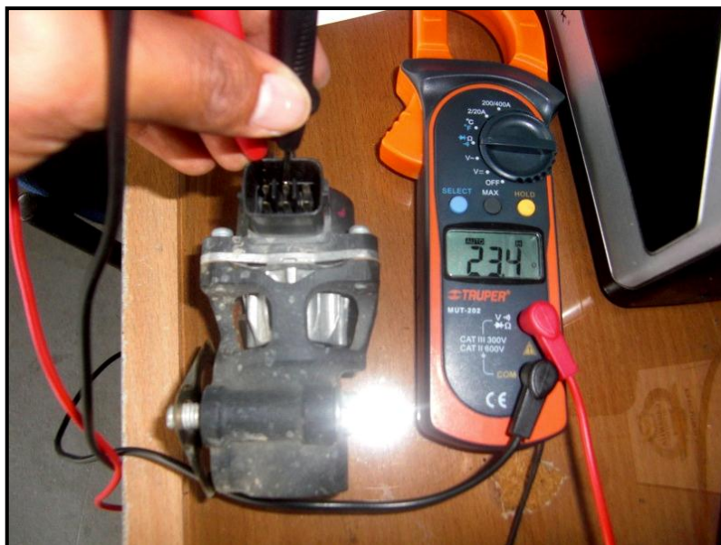
Figura 5. 54: Medición de la resistencia de la bobina B-C de la válvula EGR de motor paso a paso.
