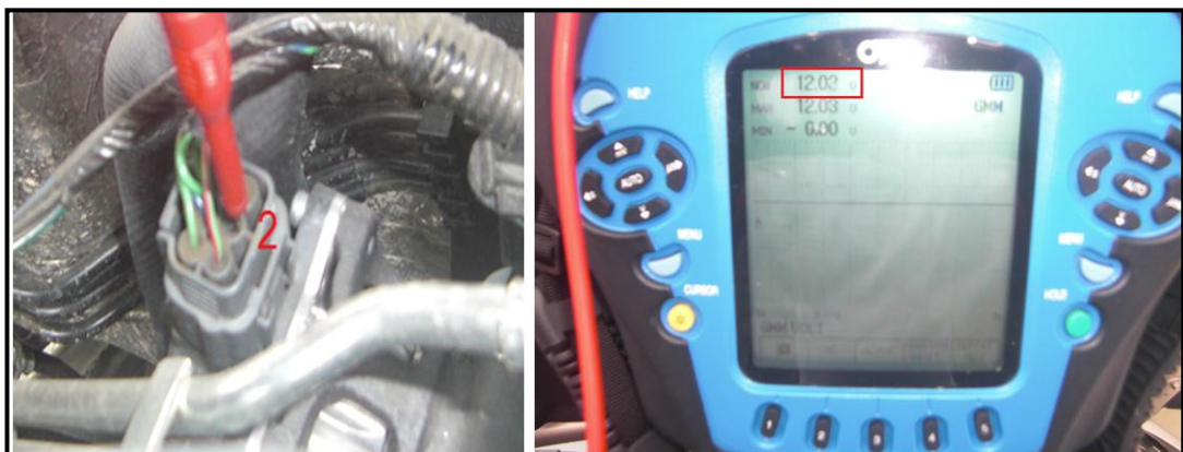
Figura 5. 27: Toma de medición y valor de voltaje en KOEO del segundo terminal de la válvula EGR de motor paso a paso.
