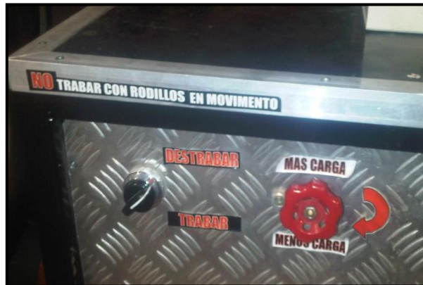
Figura 5. 63: Perilla para destrabar y trabar los rodillos del dinamómetro.
