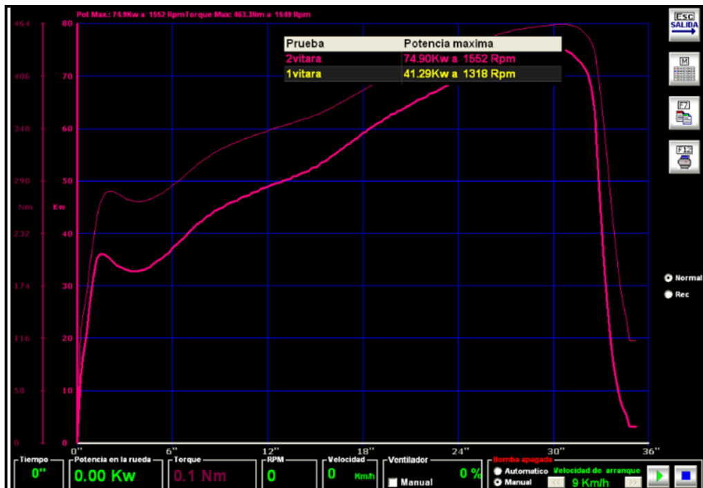
Figura 5. 70: Prueba 3 en el dinamómetro sin solenoide de purga del sistema EVAP.
