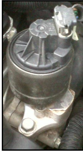
Figura 2. 35: Forma física real de una válvula EGR lineal.
