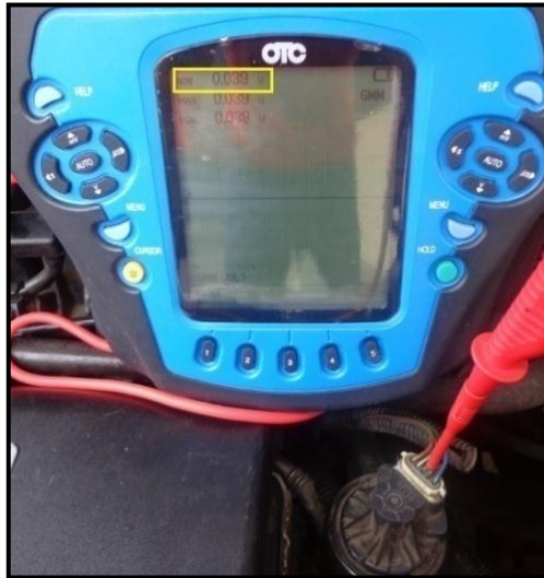
Figura 5. 35: Toma de medición y valor de voltaje en KOEO del segundo terminal de la válvula EGR lineal.
