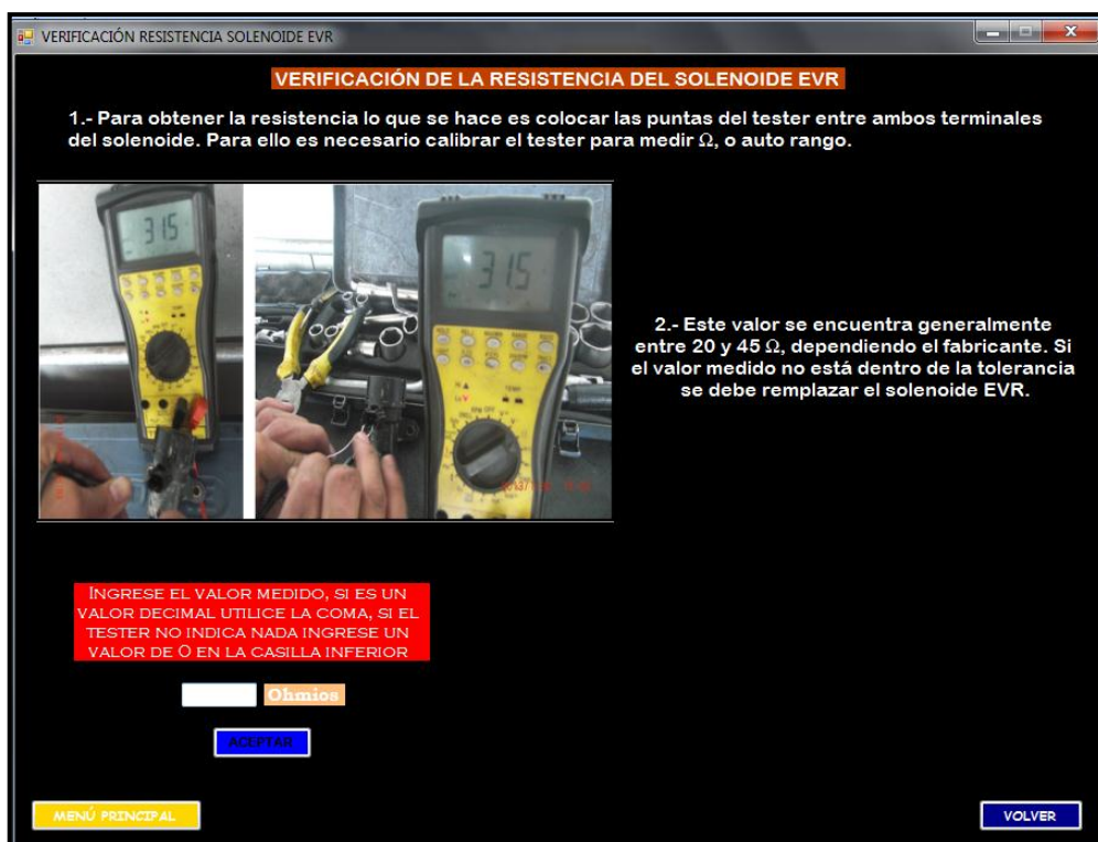
Figura 5. 113: Contenido del botón Diagnóstico con multímetro y osciloscopio dentro del submenú DIAGNÓSTICO (3).
