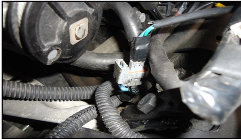
Figura 5.14: Conexión emulador - socket del inyector.
