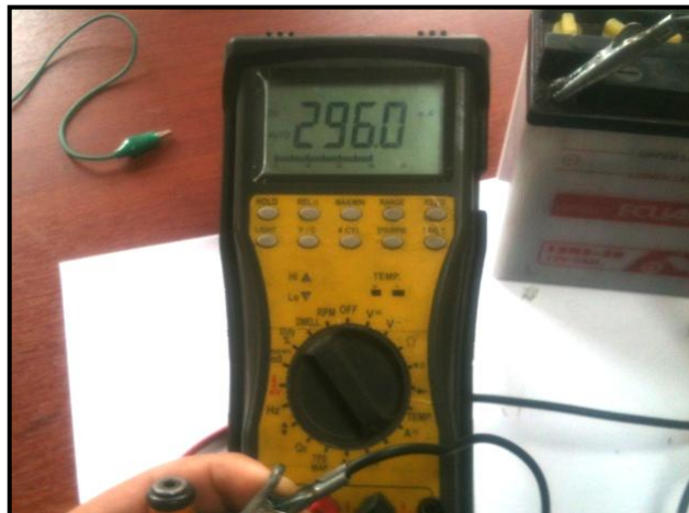
Figura 4.29: Consumo de corriente del inyector
