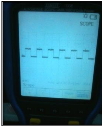
Figura 4.24: Datos sensor VSS con osciloscopio
