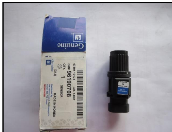
Figura 2.7: Sensor de efecto Hall - Aveo
