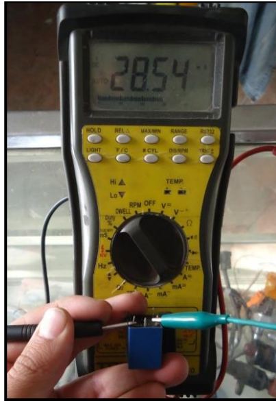
Figura 4.15: Corriente consumida por la bobina del minirelé
