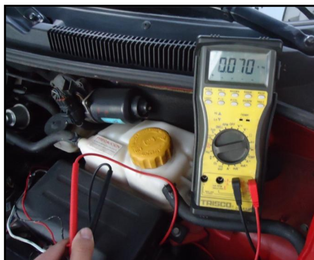
Figura 4.25: Lectura de frecuencia a 40 Km/h
