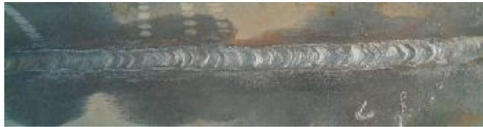
**Figura 4.12:** Cordón de soldadura de la parte externa de cuerpo.
