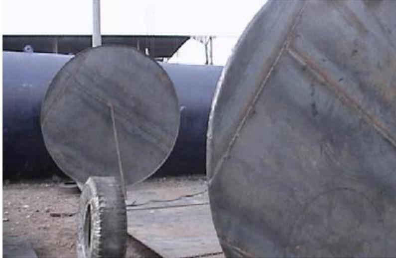
**Figura 4.5:** Cabezas ubicadas sobre los extremos de las planchas del cuerpo
