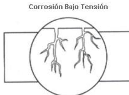
**Figura 2.14:** Esquema de la corrosión bajo tensión
