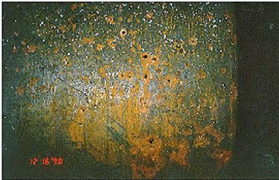
**Figura 2.7:** Corrosión por picadura en un tanque para almacenamiento de combustible exhumado.
