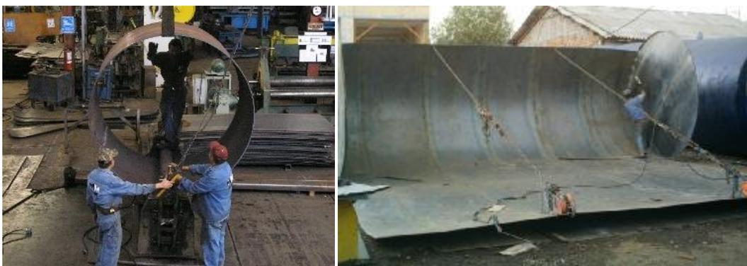
**Figura 2.21:** Procesos “a” y “b” para la construcción del cuerpo cilíndrico.
