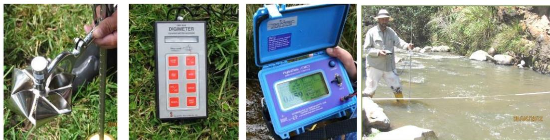
**Figura 9.** Instrumentación utilizada en la medición de caudales en la parte baja de la microcuenca
