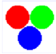
Figura 3.15. Cada píxel de una pantalla consta de tres elementos de color
