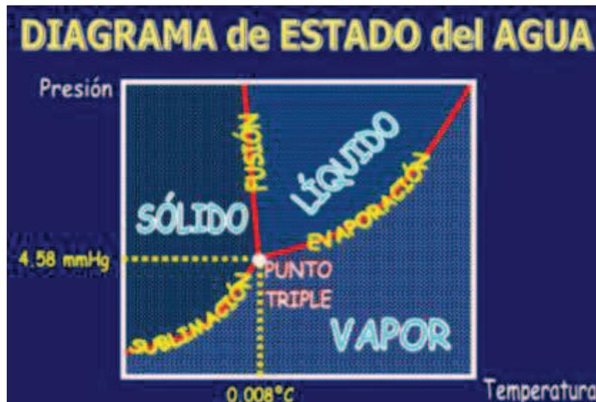
Fig.1. 8. Diagrama del punto triple del agua (Oliva y Herrera, Liofilización, 2010).
