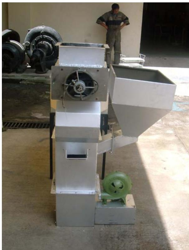
**Fotografía 15 Máquina secadora de productos agrícolas. Prototipo. Vista lateral.**
