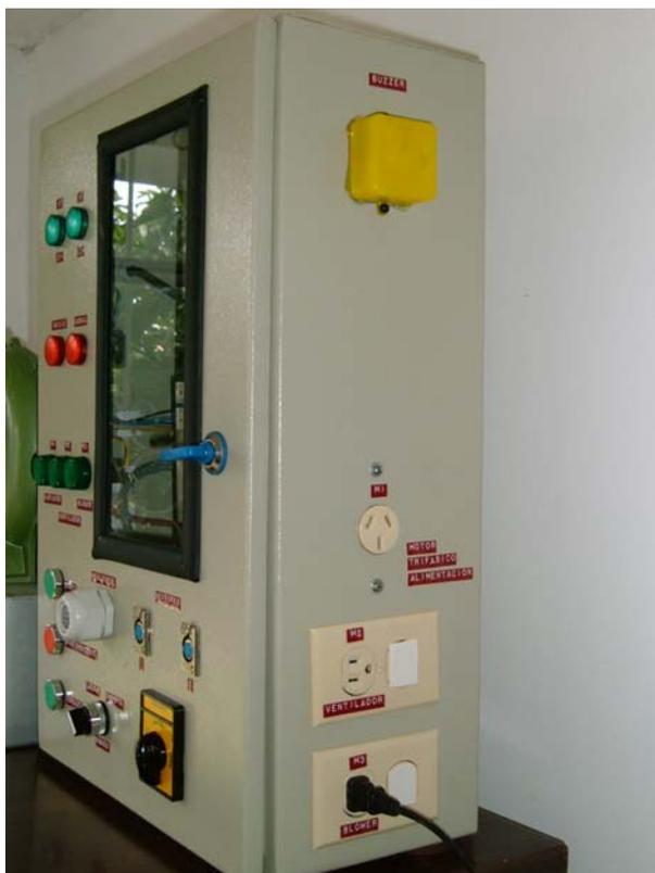
Fotografía 11 Gabinete de control terminado. Vista de conectores laterales.
