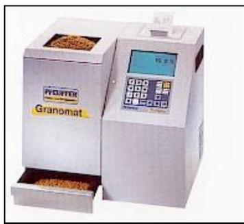
Figura 2.1 Humedímetro para granos Granomat.<sup>3</sup>
