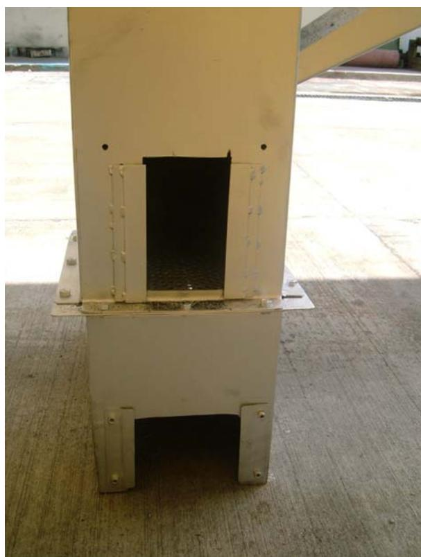
**Fotografía 16 Máquina secadora de productos agrícolas. Prototipo. Chimenea de combustión.**
