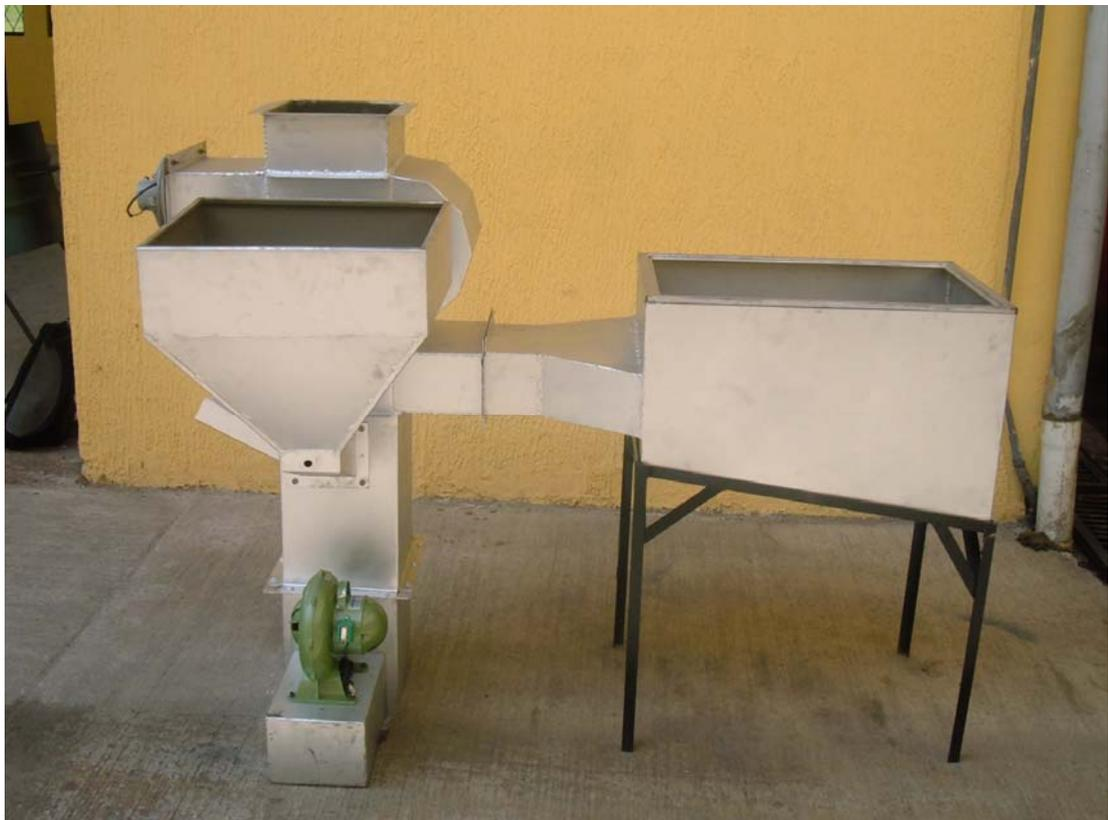
**Fotografía 14 Máquina secadora de productos agrícolas. Prototipo. Vista frontal.**
