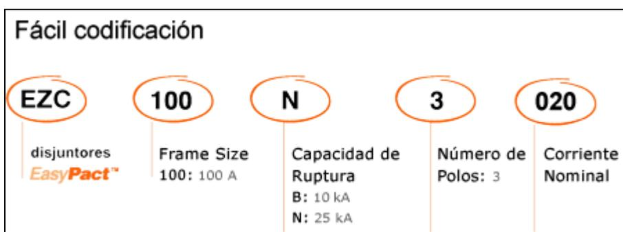
**Figura 4.7 Codificación de los Breakers principales Merlin Gerin.**
