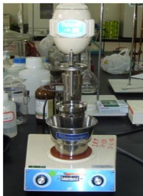
Figura 2.7 Homogenización de las preñadillas. Homogenizador Nihonseiki Kaisha, modelo Nissei AM-8
