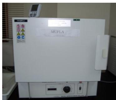
Figura 2.10 Mufla Isuzu Seisakusho Co. Ltda., modelo N° 51152126 para determinación de contenido de cenizas en las muestras de preñadilla.
