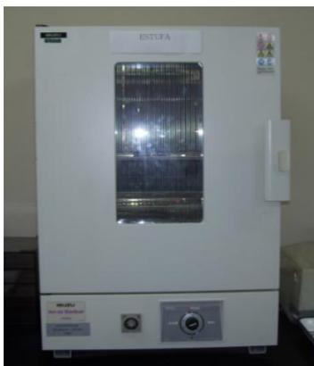
Figura 2.8 Estufa para determinar el contenido de humedad en preñadillas. Secado en estufa Isuzu Seisakusho Co. Ltda., modelo Azisai.
