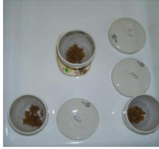
Figura 2.9 Crisoles con las muestras de preñadilla extraídas la humedad.
