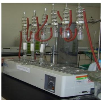
Figura 2.12 Sistema soxhlet Advantec, modelo LB-160
