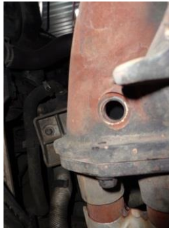
Figura 4. 32.Orificio del sensor de oxígeno en el múltiple de escape
