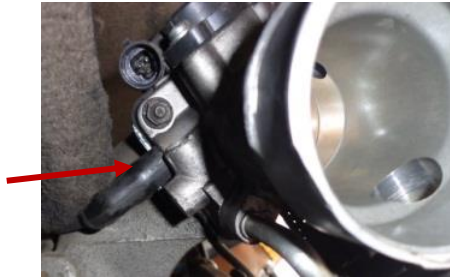
Figura 4.24. Toma de vacío del múltiple de admisión
