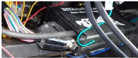
Figura 4.25. Manguera de vacío acoplada a Megasquirt
