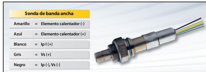
Figura 2.32. Asignación de cables de sensores NTK
