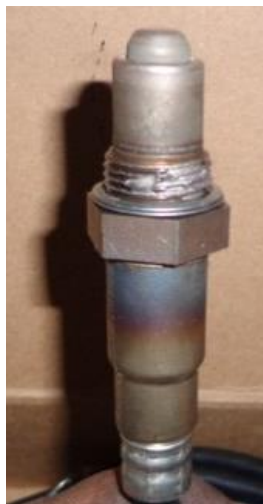
Fuente: Grupo de investigación Figura 4.29. Sensor de oxígeno en aire libre
