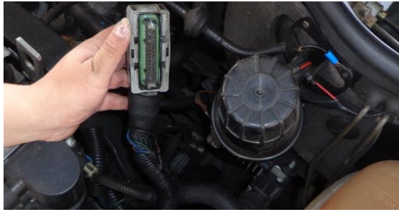
Fuente: Grupo de investigación Figura 4.7. Desmontaje del conector J1 de la Unidad de Control
