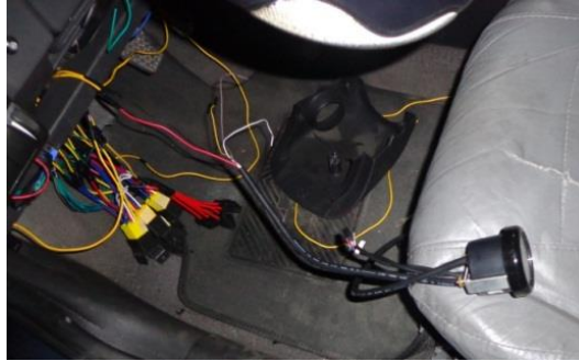
Fuente: Grupo de investigación Figura 4. 28. Instalación del Reloj indicador de AFR
