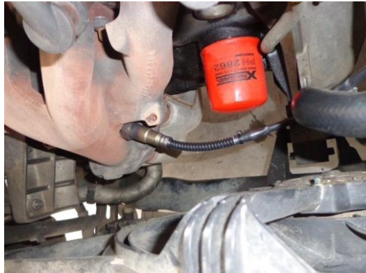
Fuente: Grupo de investigación Figura 4.33. Sensor de oxígeno de banda ancha instalado
