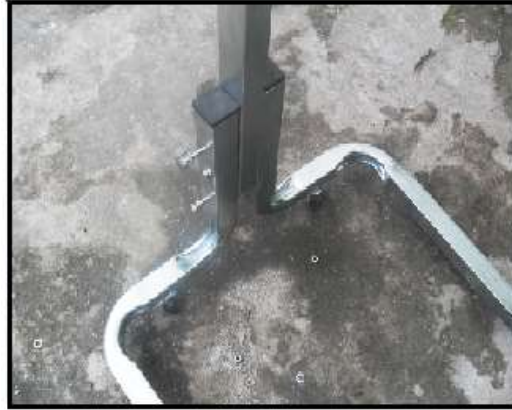
Figura 5.28. Sujeción de la columna con la base
