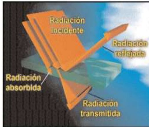
Figura 2.2. Los tres posibles efectos de la radiación sobre cualquier cuerpo
