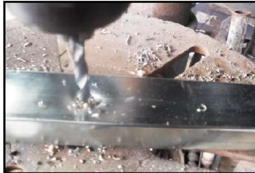
Figura 5.5. Perforación del tubo
