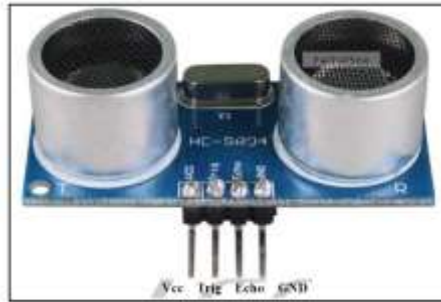
Figura 4.36. Pines del sensor ultrasónico HC-SR04
