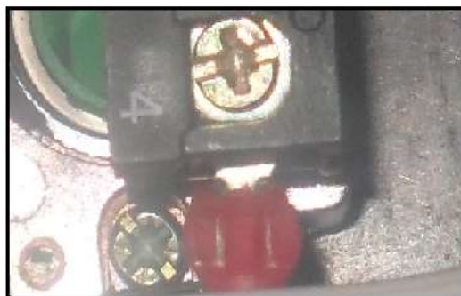
Figura 5.48. Conexión pin 4 botón inicio
