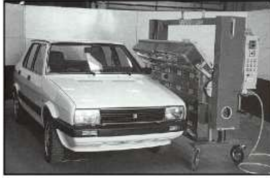
Figura 2.4. Equipo de secado por infrarrojos de onda media
