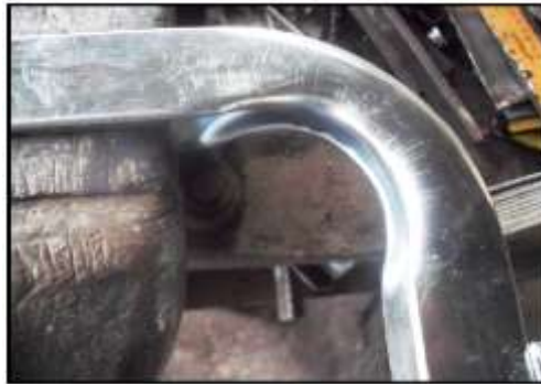
Figura 5.14. Curva a 90^\circ de las patas de la base
