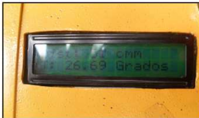
Figura 6. 9. Despliegue digital de tiempo real de distancia
