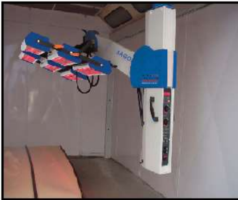
Figura 2.3. Equipo de secado por infrarrojos de onda corta
