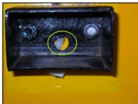
Figura 5.55. Agujero de conexión entre el HC-SR04 y el Arduino
