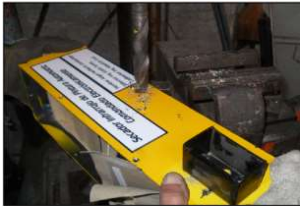
Figura 5.59. Agujero para la instalación del sensor
