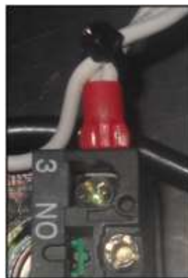
Figura 5. 47. Conexión pin 3 botón inicio
