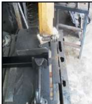
Figura 5.18. Corte del tubo de sección grande.
