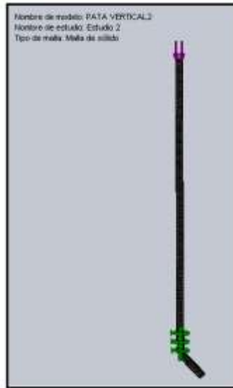
Figura 3.12. Mallado del modelo de la columna
