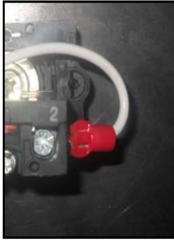
Figura 5.50. Conexión pin2 botón de emergencia
