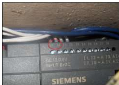
Figura 5.37. Conexión de alimentación del LOGO!
