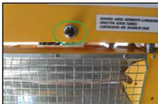
Figura 5.60. Sensor de temperatura infrarrojo RAYCI3A
