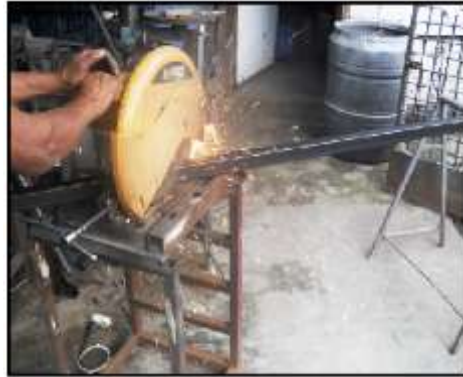
Figura 5.3. Corte de la longitud de la columna
