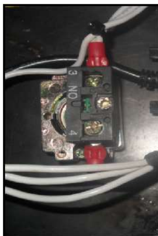
Figura 5.49. Conexión del botón inicio
