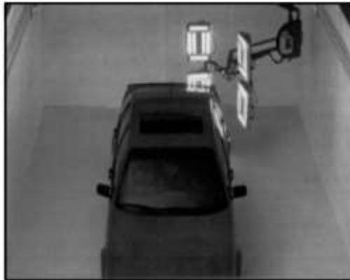
Figura 2.6. Endurecimiento de una pequeña área de pintura usando lámparas secadoras infrarrojas
