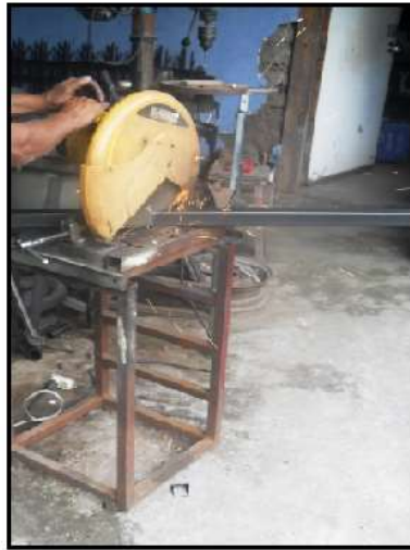
Figura 5.11. Corte de los tubos de la base
