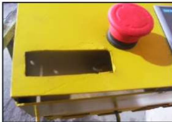
Figura 5.57. Orificio del LCD
