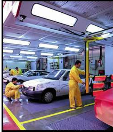
Figura 2.8. Equipo de secado por infrarrojos portátil
