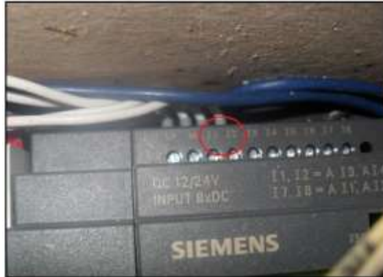
Figura 5.38. Conexión de las entradas del LOGO!
