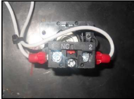
Figura 5.52. Montaje del botón de emergencia
