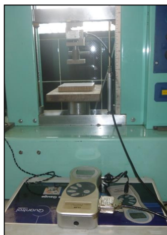
Figura 4.3: Ensayo de compresión de c-board en la máquina de ensayos cíclicos
