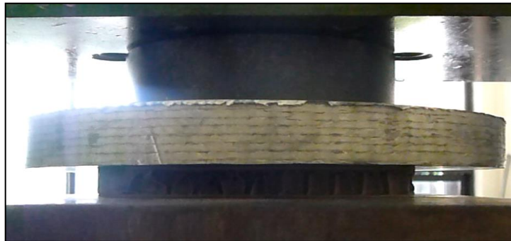
Figura 4.4: Falla del c-board sometido a compresión
