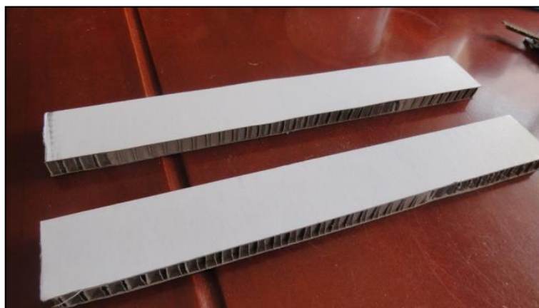
Figura 4.7: Probetas para ensayo de flexión de c-board
