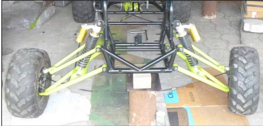
Figura 6.6: Conjunto mesas-amortiguador delantero armado
