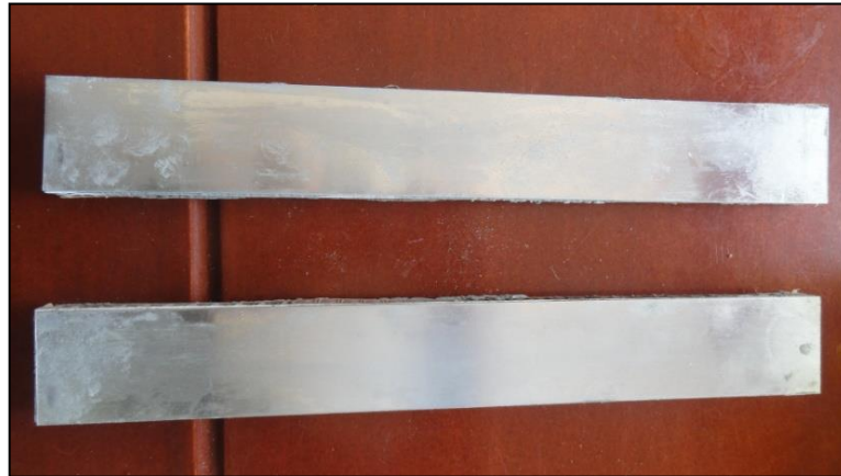
Figura 4.8: Probetas para ensayo de flexión de sánduche
