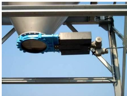
Figura 1.12. Descarga por gravedad.
