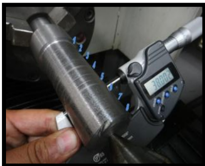
Fig. 20. Medición del cilindrado
