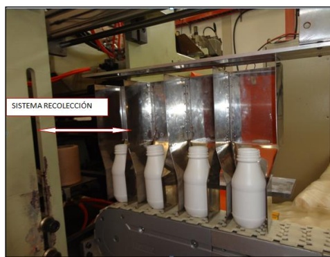
Figura 3.3 Montaje del sistema de recolección Elaborado por: Roberto Guishcacho y Javier Pilamonta
