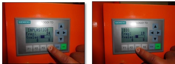
Figura 3.19 Prueba de variación de frecuencia con la TD. Elaborado por: Roberto Guishcasho y Javier Pilamonta
