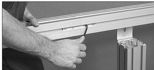
Figura 3.8 Apriete de tornillos de ajuste. Elaborado por: Roberto Guishcasho y Javier Pilamonta.
