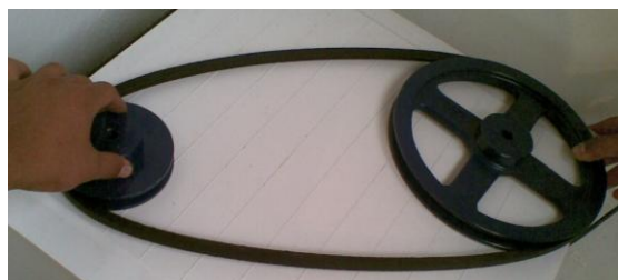
Fig. 3. 11 Banda tipo A de 50" Fuente: Investigación de campo Editado por: Lenin Carrazco
