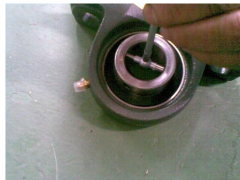
Fig. 3. 28 Medición diámetros exterior e interior Fuente: Investigación de campo Editada por: Lenin Carrazco
