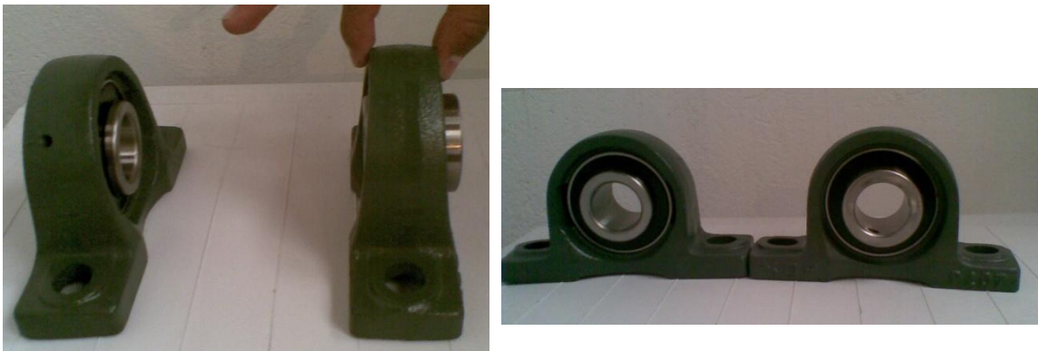
Fig. 3. 13 Chumaceras de piso de 1 ¼ " Fuente: Investigación de campo Editado por: Lenin Carrazco
