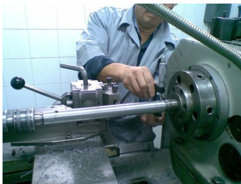
Fig. 3. 28 Medición diámetros exterior e interior Fuente: Investigación de campo Editada por: Lenin Carrazco
