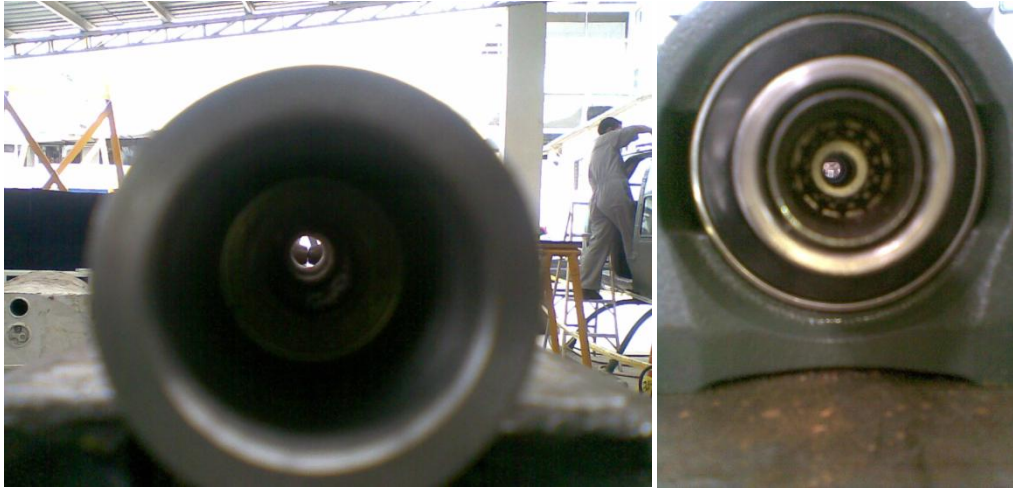
Fig. 3. 29 Alojamiento del estriado hembra Fuente: Investigación de campo Editada por: Lenin Carrazco
