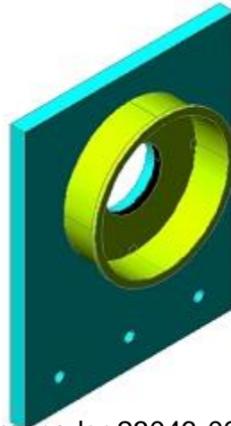
Fig. 3. 15 Diseño de soporte para el arrancador 23046-020 Fuente: Investigación de campo Editado por: Lenin Carrazco
