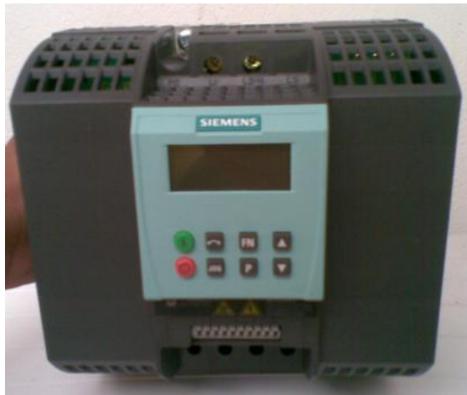
Fig. 3. 4 Variador de velocidad Sinamic G110 Fuente: Investigación de campo Editado por: Lenin Carrazco
