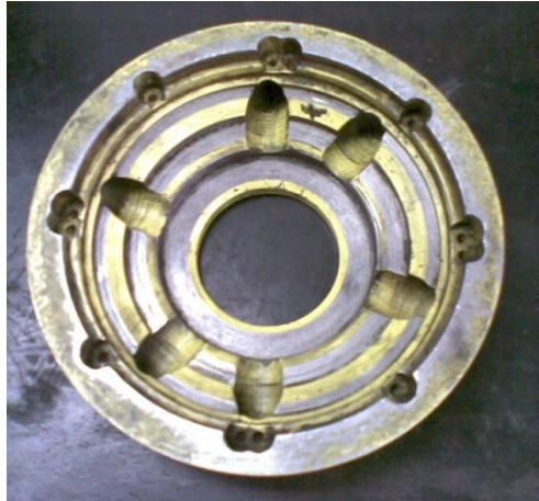
Fig. 3. 25 Soporte removible generadores 23032-018 (Bell 206) Fuente: Investigación de campo Editada por: Lenin Carrazco
