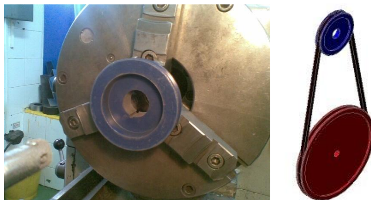
Fig. 3. 35 Construcción del canal para la chaveta Fuente: Investigación de campo Editada por: Lenin Carrazco
