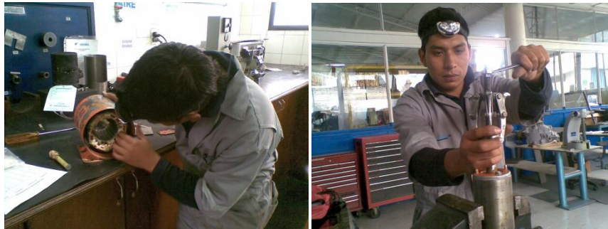
Fig. 3. 20 Mantenimiento estator y cambio de rodamientos Fuente: Investigación de campo Editada por: Lenin Carrazco
