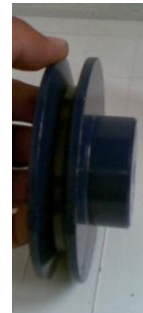
Fig. 3. 10 Polea de 4" de diámetro Fuente: Investigación de campo Editado por: Lenin Carrazco
