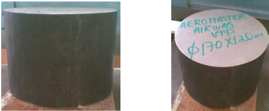
Fig. 3. 14 Eje redondo Acero V945
