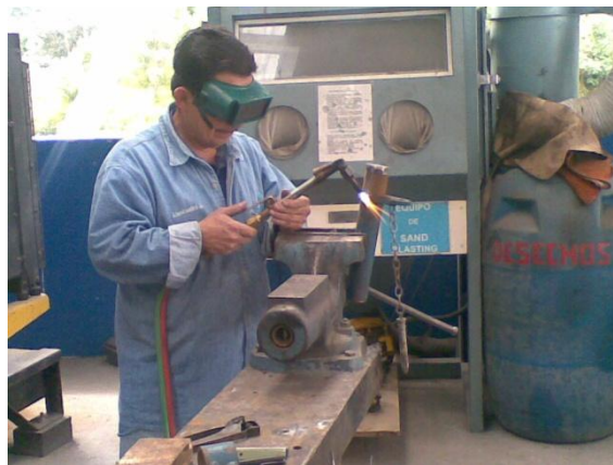
Fig. 3. 26 Corte del eje en bruto Fuente: Investigación de campo Editada por: Lenin Carrazco
