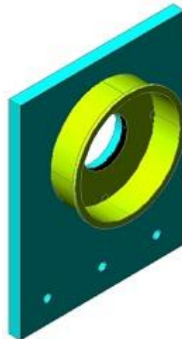
Fig. 3. 16 Diseño de soporte para el arrancador 23032-018 Fuente: Investigación de campo Editado por: Lenin Carrazco
