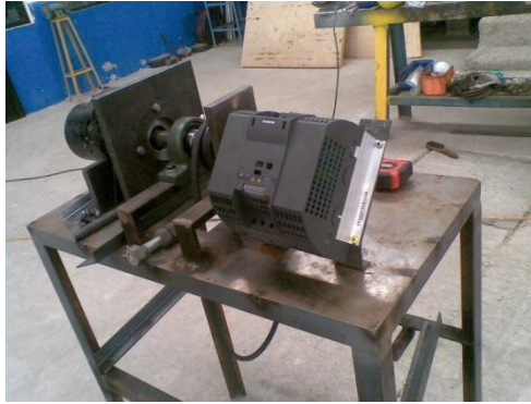
Fig. 3. 38 Montaje del variador de velocidad Fuente: Investigación de campo
