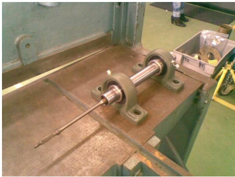
Fig. 3. 33 Chumaceras y eje Fuente: Investigación de campo Editada por: Lenin Carrazco
