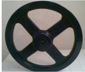
Fig. 3. 9 Polea de 9" de diámetro Fuente: Investigación de campo Editado por: Lenin Carrazco
