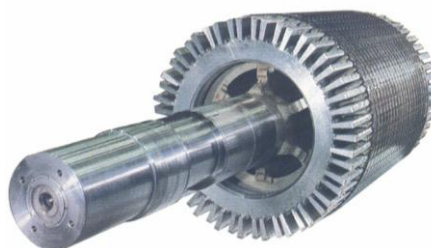
Fig. 2. 62 Rotor tipo jaula de ardilla Fuente: tuveras.com Editado por : Lenin Carrazco
