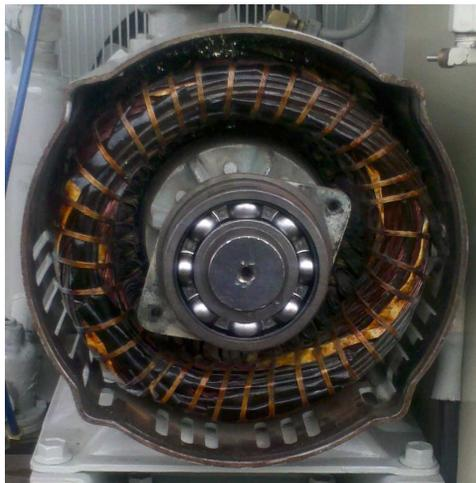
Foto 8. Rodamiento Motor Trifásico de 30 HP
