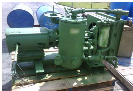
Foto 5. Compresor Ingersoll Rand (Lijado y con pintura de fondo)
