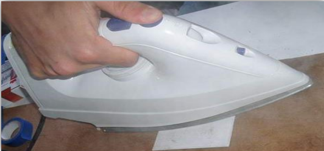
Figura 3. 51. Planchado de placa
