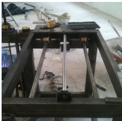
Fig. 5. 8 Prueba en el taller mecánico del movimiento del tornillo de bolas
