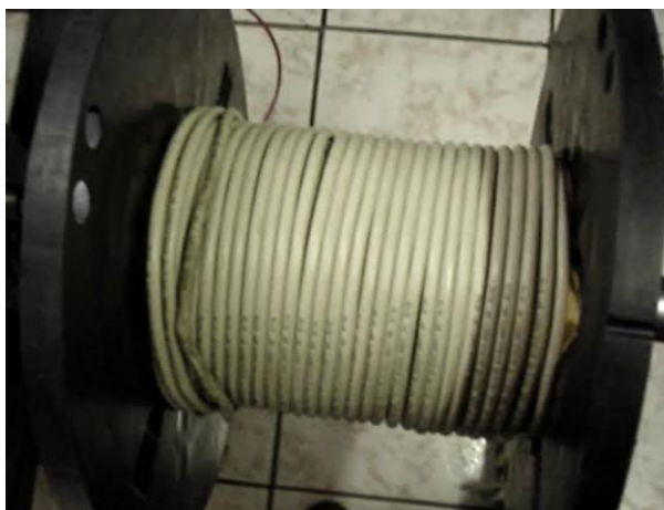
Fig. 6. 9Presentación del carrete bobinado manual para cable multi-hilos 4x AWG 19 resultado final
