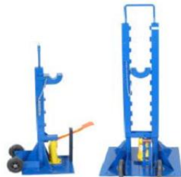
Fig. 2.3a Transportador tipo hidráulico con gata
