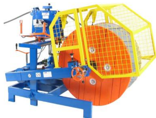
2.4 d Bobinadora hidráulica con mesa de distribución manual
