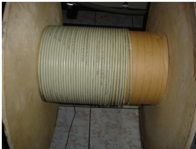
Fig. 6. 12 Prueba de bobinado para cable multi-hilos 4xAWG19 resultado final
