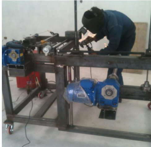
Fig. 5. 9 Prueba en taller mecánico del movimiento de los actuadores MA5
