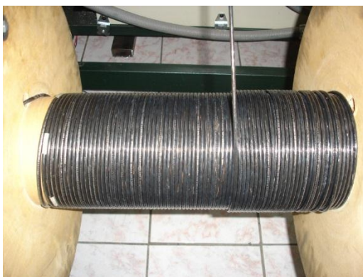
Fig. 6. 11 Prueba de bobinado para cable AWG10 resultado final
