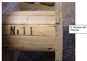
2.5 a Bobina de madera: Flanche - tambor
