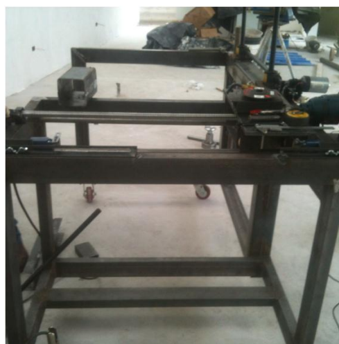
Fig. 5. 8 Prueba en el taller mecánico del movimiento del tornillo de bolas
