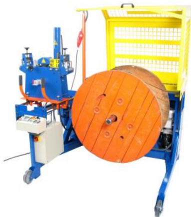
2.4 c Bobinadora con mesa de distribución manual y motor eléctrico
