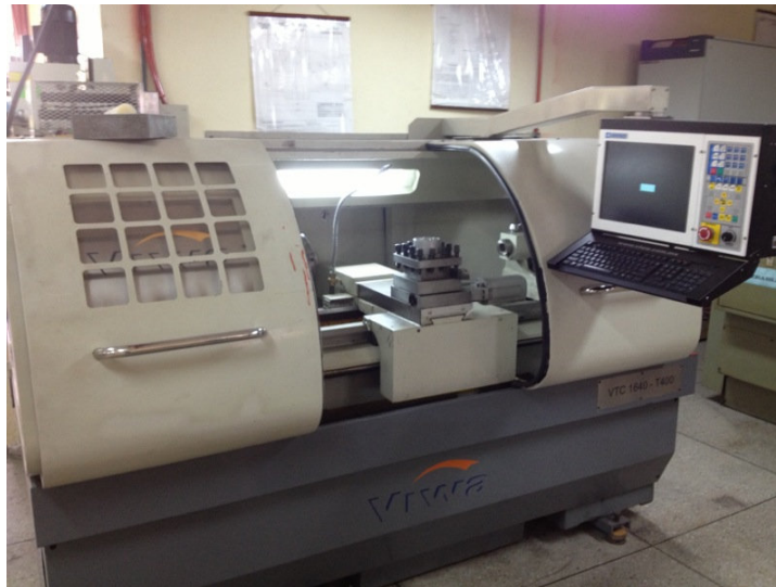
Figura 5.4: Torno CNC de la Escuela Politécnica del Ejército
