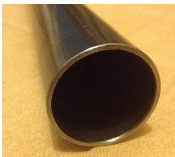
Figura 5.1: Cuerpo: Tubería ASTM A500
