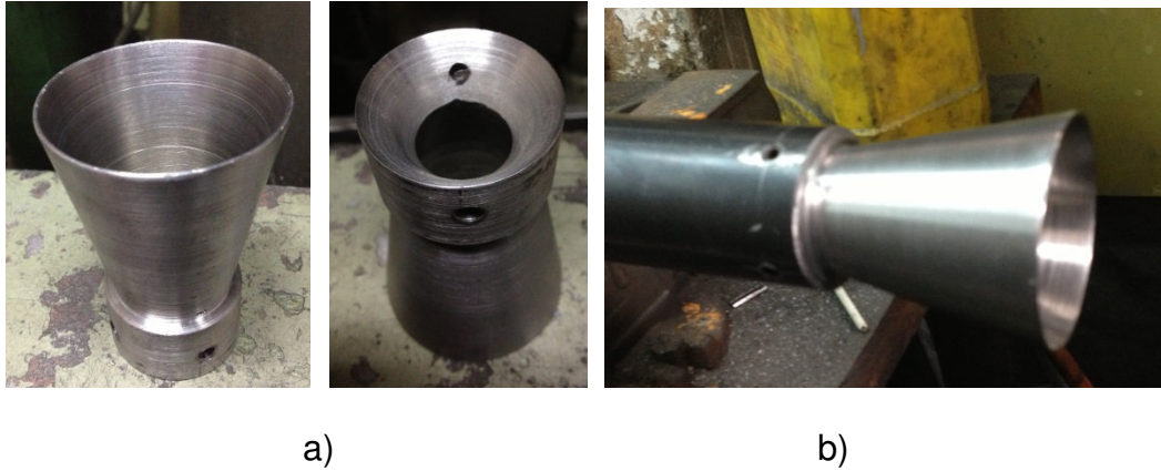
Figura 5.10: a) Tobera terminada b) tobera ensamblada en el cuerpo
