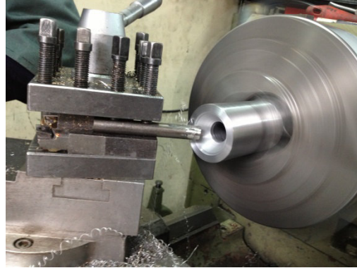
Figura 5.8: Proceso de torneado interno de la tobera.
