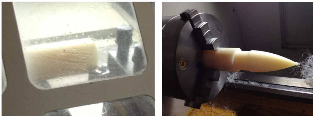
Figura 5.6: Acabado final de la nariz tipo ojiva en torno CNC
