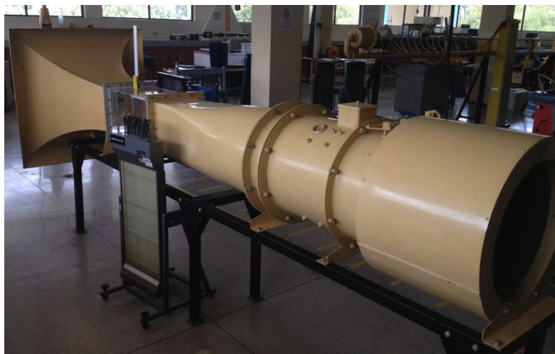
Figura 5.14: Túnel de viento de marca Plint Partners, con una velocidad máxima de 30 m/s usando un motor de 2900 rpm, creado en el año 1981 y con una capacidad en la cámara de trabajo de 30 x 30 cm.
