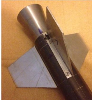
Figura 5.12: Aleta de aluminio de 2 mm
