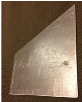
Figura 5.11: Aleta de aluminio de 2 mm
