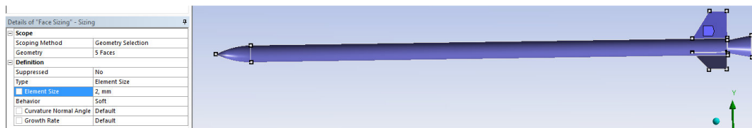
Figura 4.14: Refinamiento del mallado
