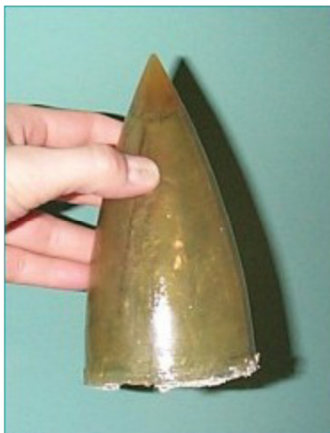
Figura 2.12: Cono de poliéster reforzado con fibra de vidrio
