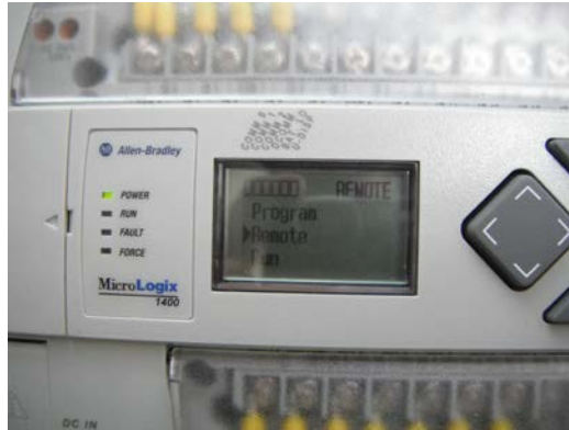
Foto.3.22: PLC en modo remoto Fuente: Empresa AYMESA S.A 2012
