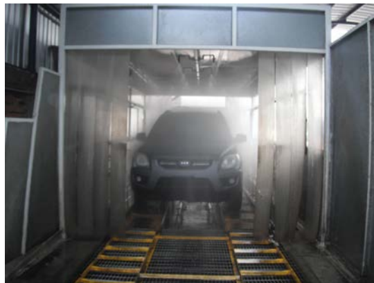
Foto.4.2: Pruebas en la cabina de agua Fuente: Empresa AYMESA S.A 2012
