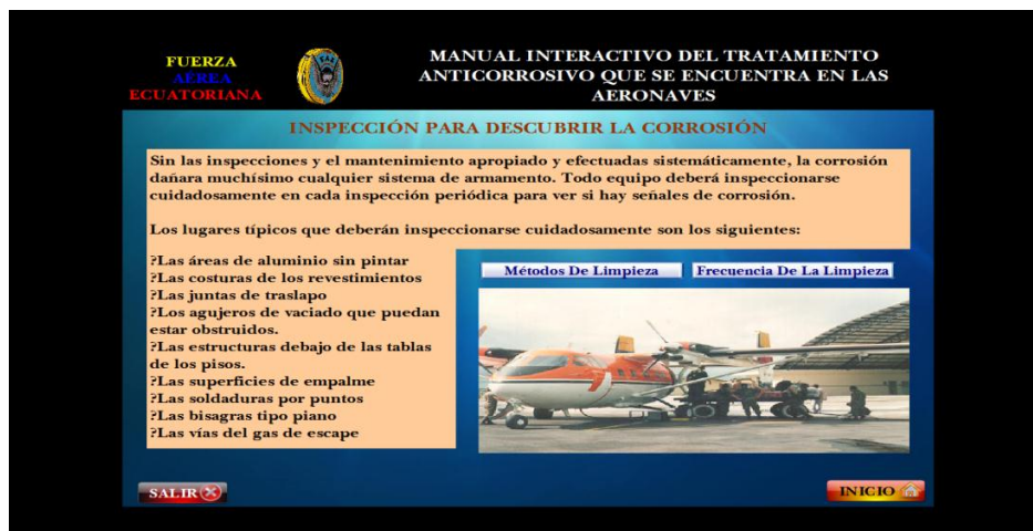
Figura 3.47: Inspección para descubrir la corrosión Elaborado por: Cbos. Paucar Wilmer
