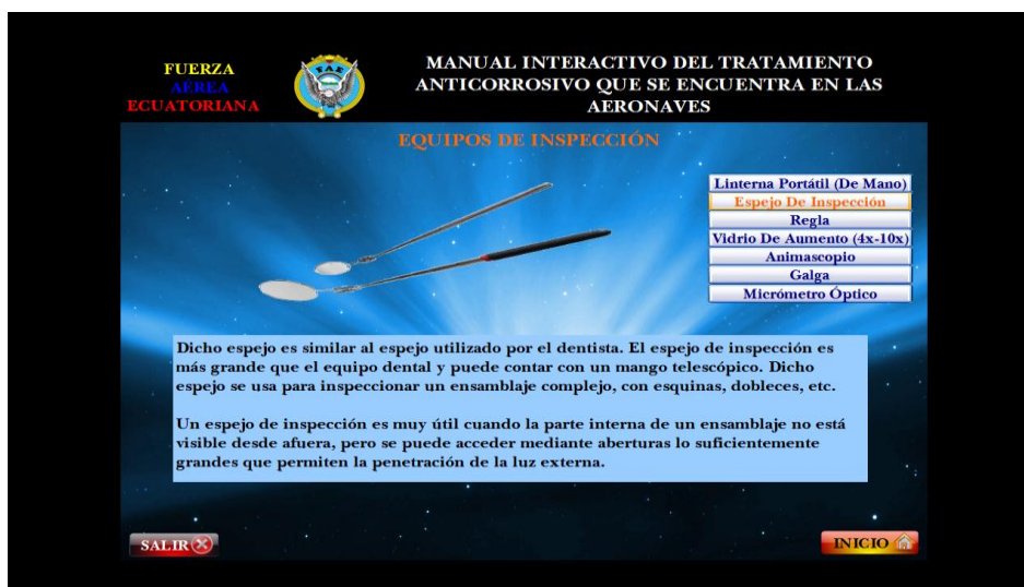
Figura 3.49: Equipos de inspección Elaborado por: Cbos. Paucar Wilmer
