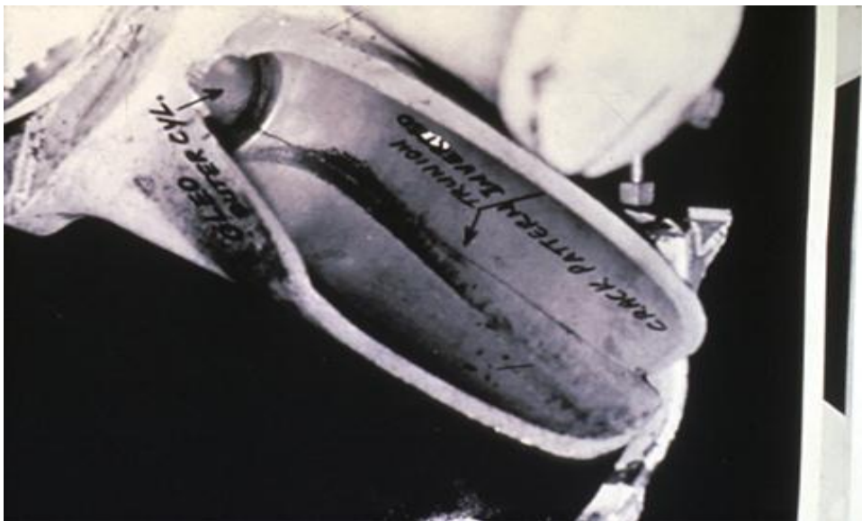
Figura 2.12: Corrosión por rozamiento
