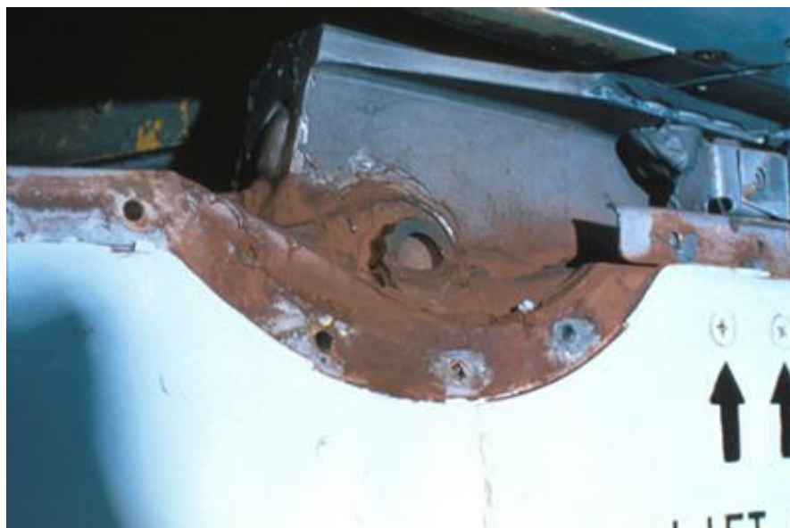
Figura 2.7: Corrosión en hendidura
