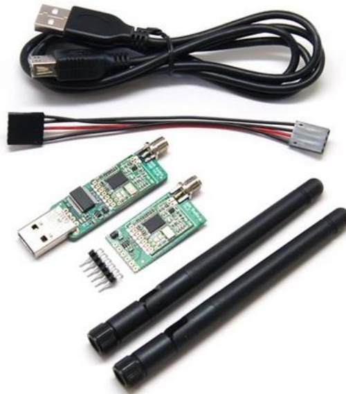
Figura 2.5: Kit de radio telemetría 3DR.
