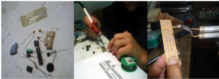
Foto 3.7: Soldando los elementos en la placa.
