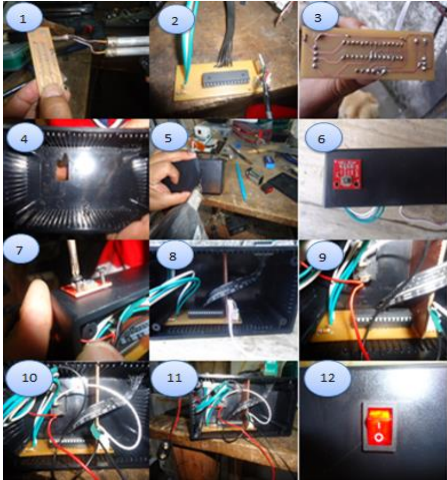
Foto 15: Pasos para la construcción del módulo de comunicación
