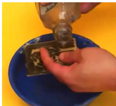
Foto 3.6: Lavar la placa con acetona
