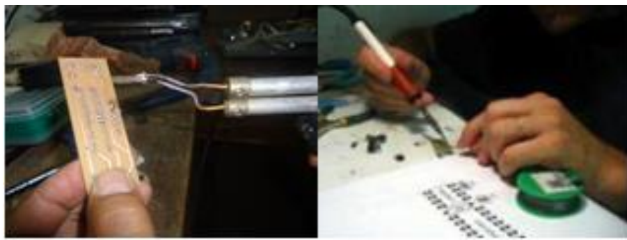
Foto 3.14: Soldando los componentes
