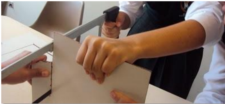
Foto 3.1: Cortar la baquelita Fuente: Investigación de campo
