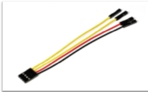
Figura 2.10 Cable de telemetría
