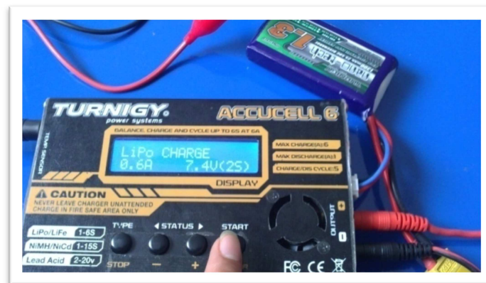
Foto 3.19 Programación para cargar la batería L-PO Fuente: Investigación de campo.
