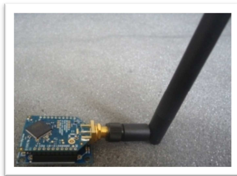
Foto 3.5 Módulo RPSMA conectada con la antena. Fuente: Investigación de campo
