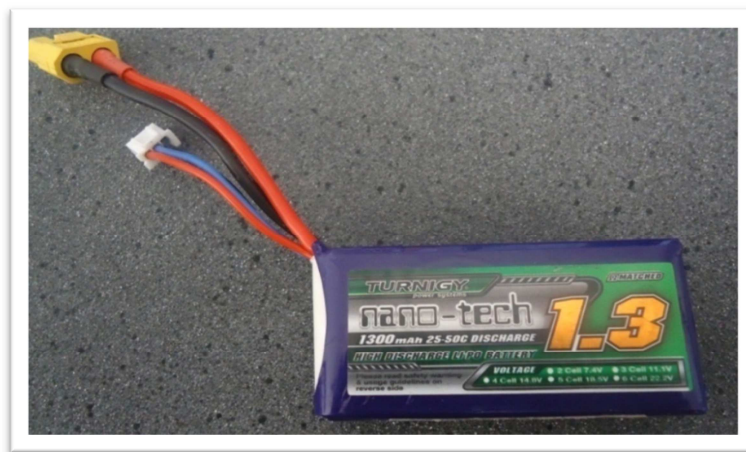
Foto 2.1 Batería LI-PO Fuente: Investigación de campo.
