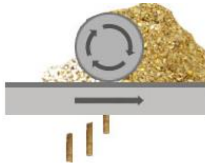
Figura 29 Esquema movimiento rodillo sobre matriz plana.
