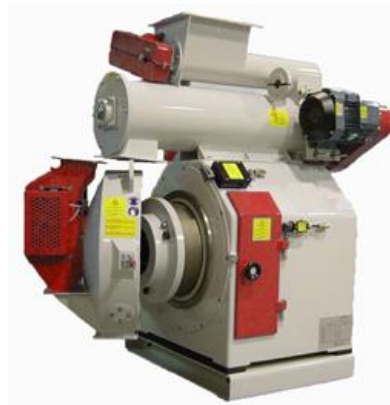
Figura 28 Máquina Granuladora de Matriz Anular. Fuente: www.segra.es/equipogranulacion.html
