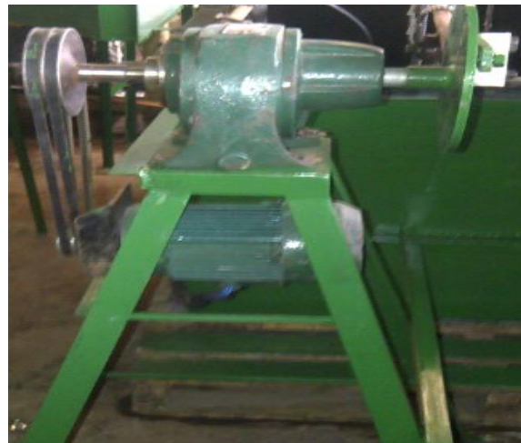
Figura 0.35: Montaje del Sistema de Agitación.
