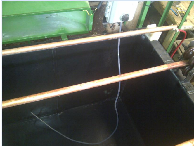
Figura 0.42: Ubicación del Sensor del Termostato.
