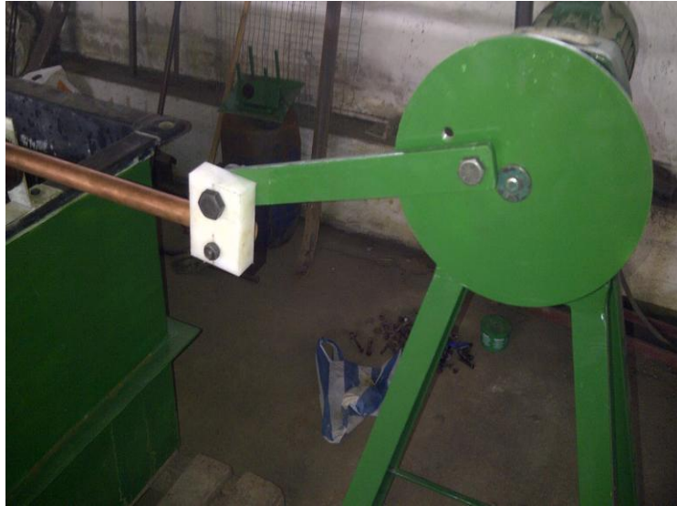
Figura 0.22: Ensamble del Sistema de Agitación.
