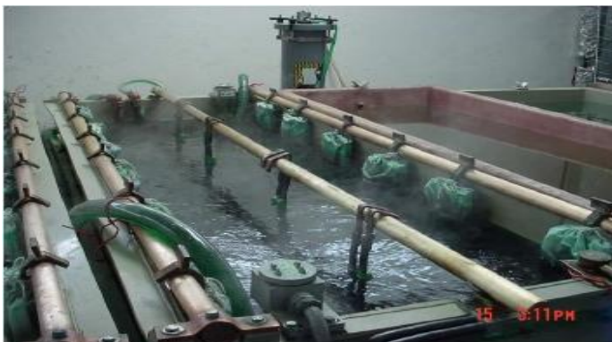
Figura 0.2: Tina de baño de Níquel. 11
