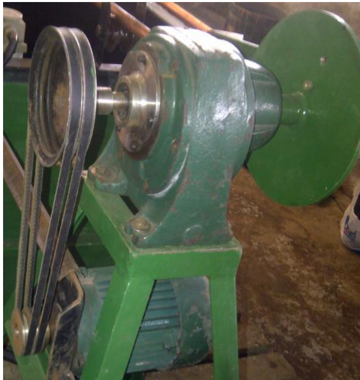
Figura 0.23: Ensamble del Motor - Reductor Mediante Bandas
