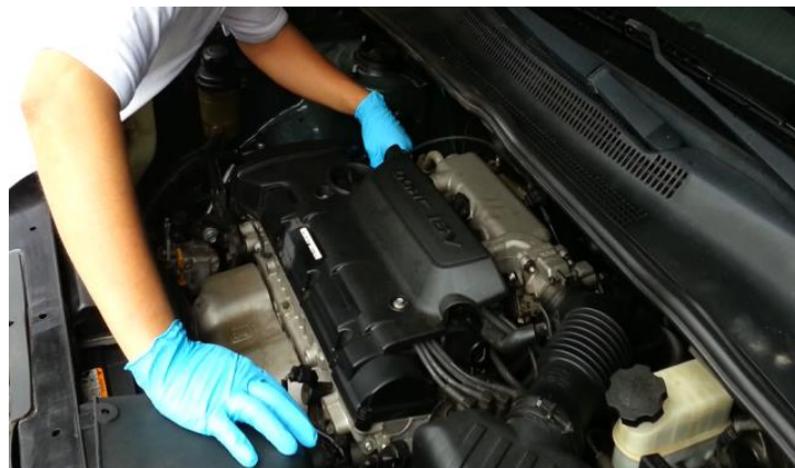
Gráfica20 Comprobación de fugas de combustible en el sistema de inyección. Fuente: (PASCAR's, 2014).
