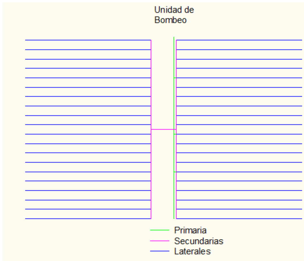
Figura 2. 3. Alternativa constructiva N.º3 10
