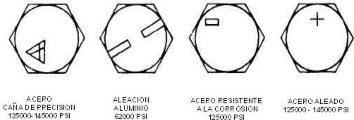
**Fig.2.26:** Forma de cabezas de tuercas y tornillos
