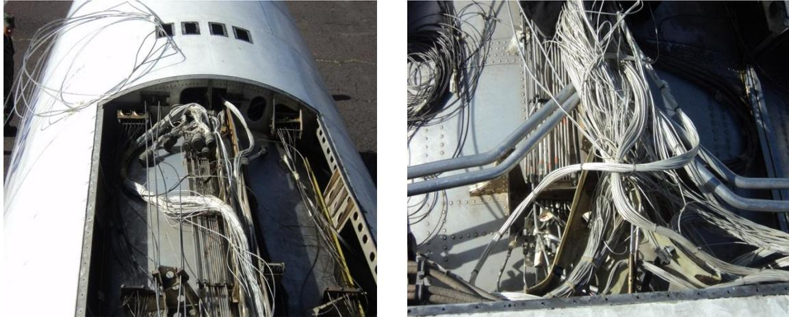
**Fig.3.11:** Conexiones de arneses eléctricos.
