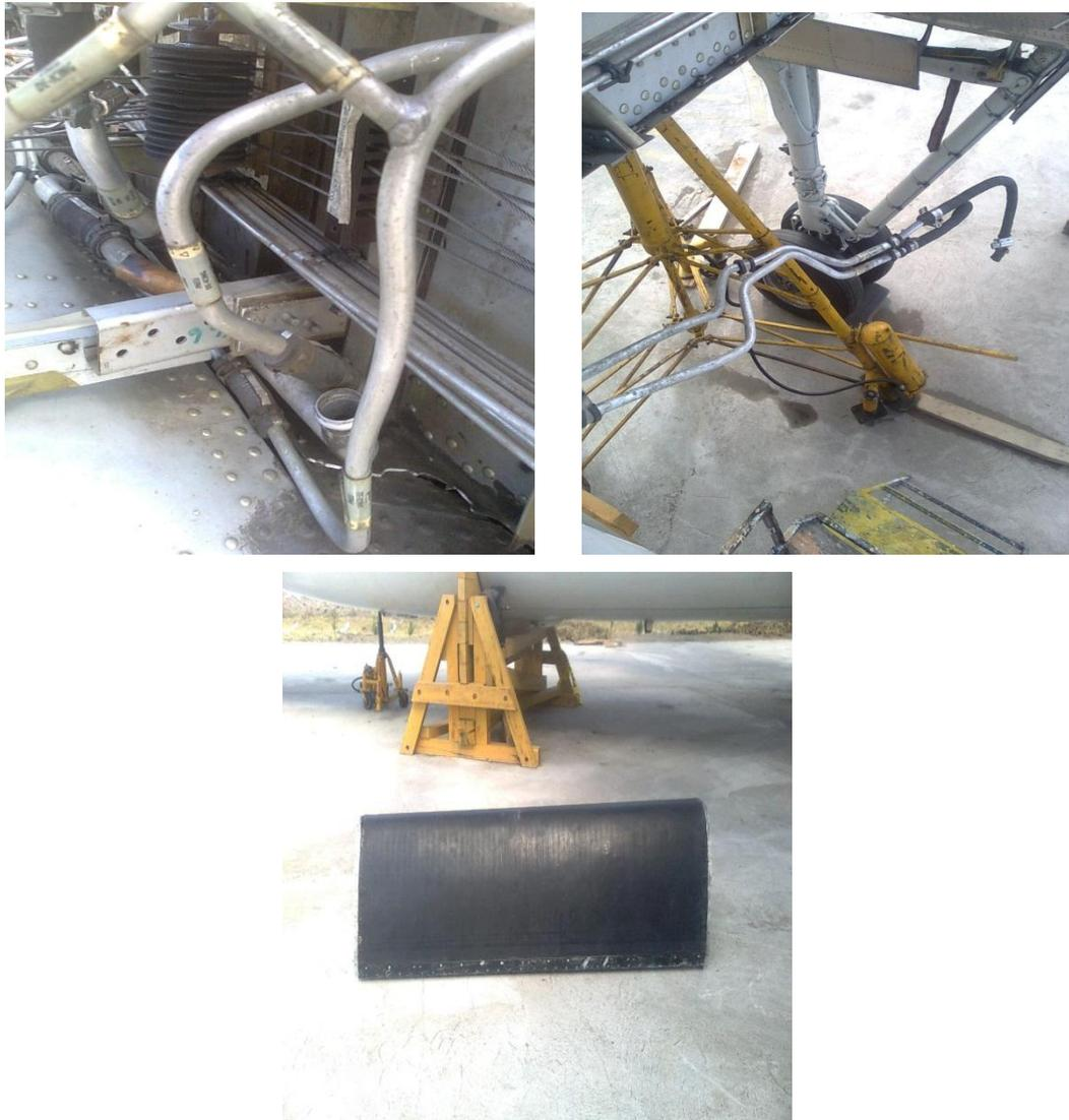
**Fig.3.13:** Conexiones del borde de ataque.
