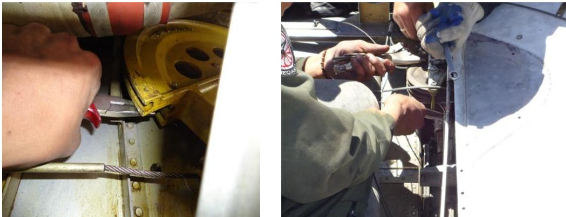
**Fig.3.12:** Conexiones de cables y poleas.
