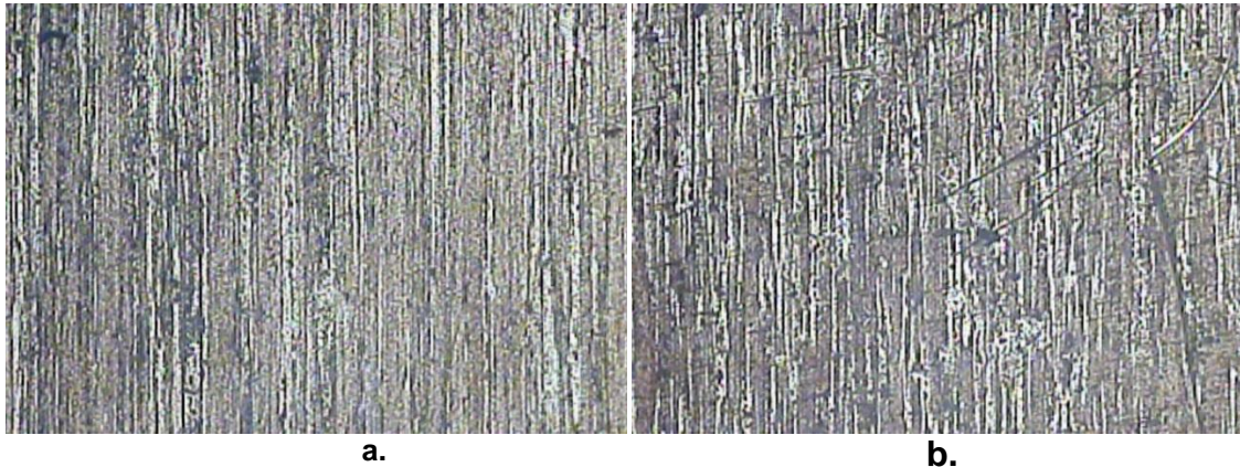
Figura 7.16 Metalografía de la probeta de la aleación de aluminio 2011-T3 a 100\times^{50} . a.) Sin tratamiento térmico b.) Después del tratamiento térmico (temperatura de recristalización)
