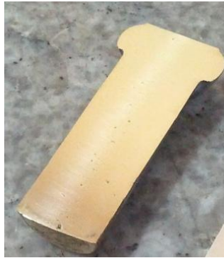
Figura 7.10 Probeta aleación de cobre cortada a la mitad y pulida con alúmina 48
