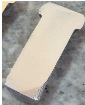
Figura 7.6 Probeta aleación aluminio cortada a la mitad y pulida con alúmina 48
