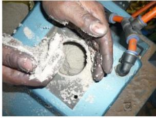
**Figura 5 Ingreso manual de arena al bloque de soplado**
