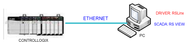
Fig.5. Comunicación Controlador ControlLogix
